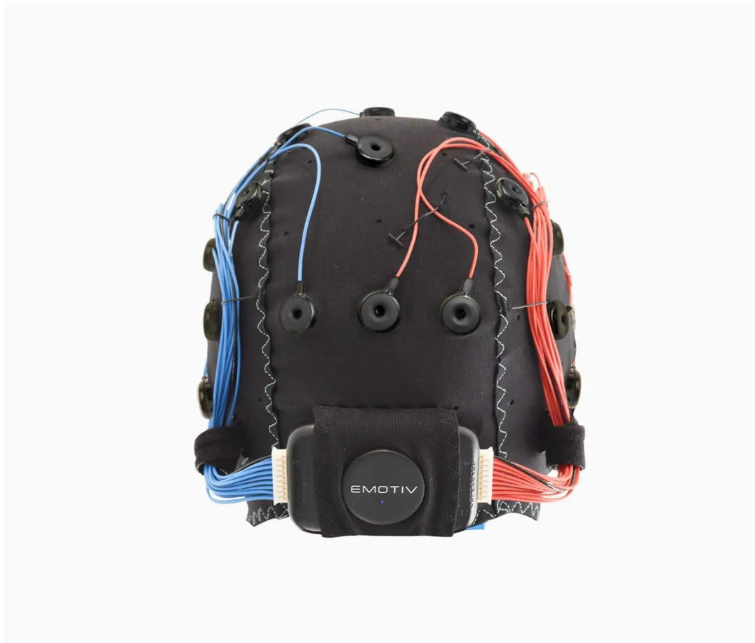
Σχήμα 10 Η συσκευή απαγωγής εγκεφαλογραφημάτων emotiv Flex
