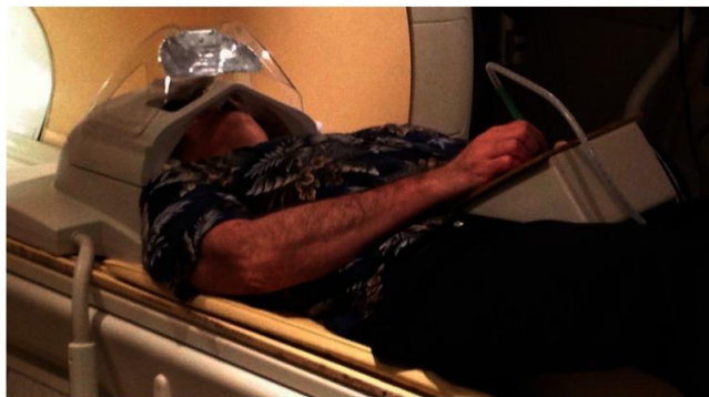
20. Ένα tablet χρησιμοποιείται κοντά στην είσοδο του μαγνητικού τομογράφου (MRI). Το στυλό του είναι συνδεδεμένο με οπτική ίνα που διέρχεται μέσω ενός οπτικού αγωγού (waveguide) τοποθετημένου στον τοίχο του δωματίου του τομογράφου. (Reitz et al. 2013)
