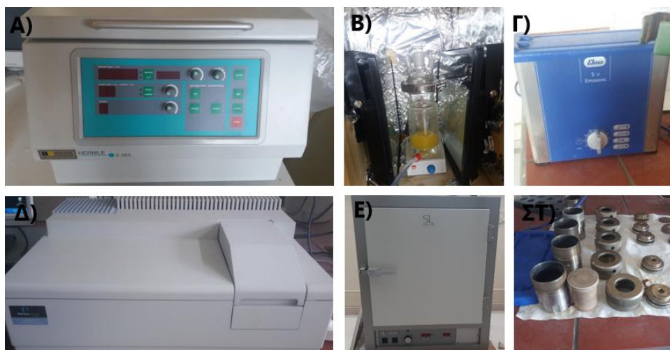
Σχήμα 19. Α) Φυγόκεντρος, Β) Διάταξη φωτοκατάλυσης μαζί με τον αντιδραστήρα, Γ) Λουτρό υπερήχων, Δ) Φασματοφωτόμετρο UV/VIS, Ε) Φούρνος αντίδρασης και ΣΤ) Φορείς ανοξείδωτου χάλυβα υδροθερμικής αντίδρασης και αυτόκλειστα Teflon.
