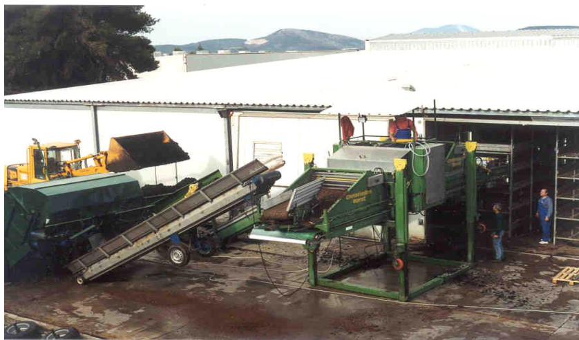
4. Γέμισμα θαλάμων καλλιέργειας με επωασμένο «κομπόστ».
