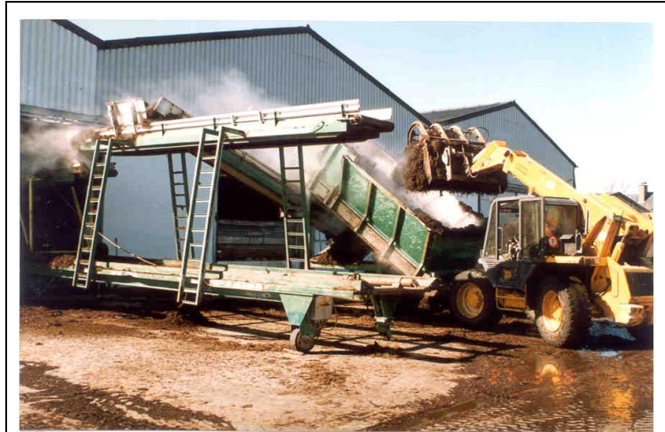
3. Γέμισμα τούνελ παστερίωσης με ζυμωμένο «κομπόστ».
