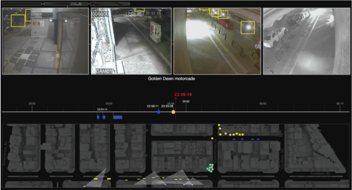
Εικόνα 8: Πλάνα από πολλαπλές κάμερες CCTV κοντά στον τόπο της δολοφονίας συγχρονίζονται και η κίνηση ανθρώπων και οχημάτων μεταξύ των καρέ αποτυπώνεται σε ένα τρισδιάστατο μοντέλο.
