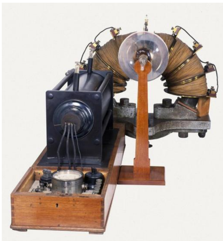
Εικόνα 1. Πρωτότυπος αναλυτής φασματομετρίας μάζας του Aston (Sutton, 2022)
