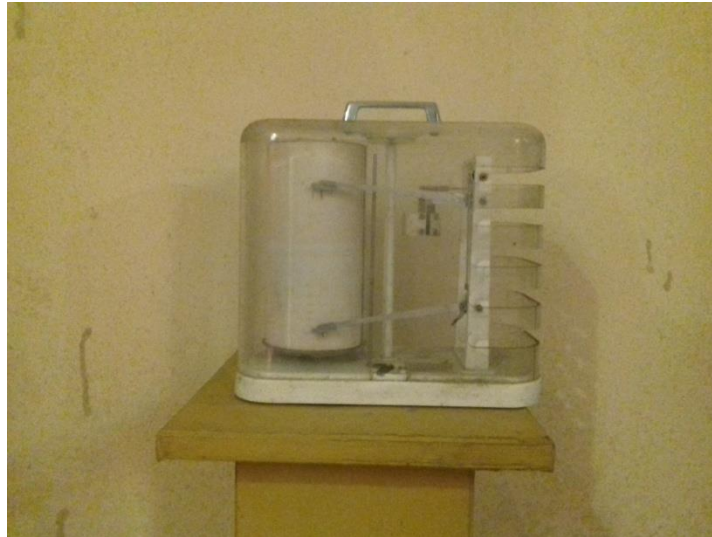
Εικόνα 37: Υγρασιόμετρο για τον προσδιορισμό της υγρασίας του κελαριού. Χρησιμοποιήθηκε πριν κυκλοφορήσουν τα ηλεκτρονικά, πηγή: προσωπικό φωτογραφικό αρχείο από το Κτήμα Γκλίναβος
