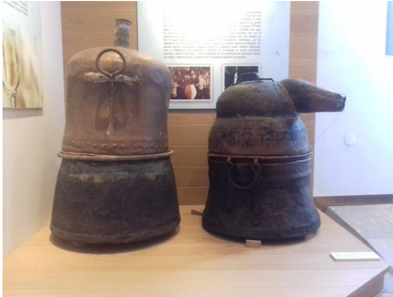
Εικόνα 49: Οι δυο διαφορετικοί τύποι παραδοσιακού άμβυκα, πηγή: Μουσείο Αμπέλου και Οίνου Ηπείρου
