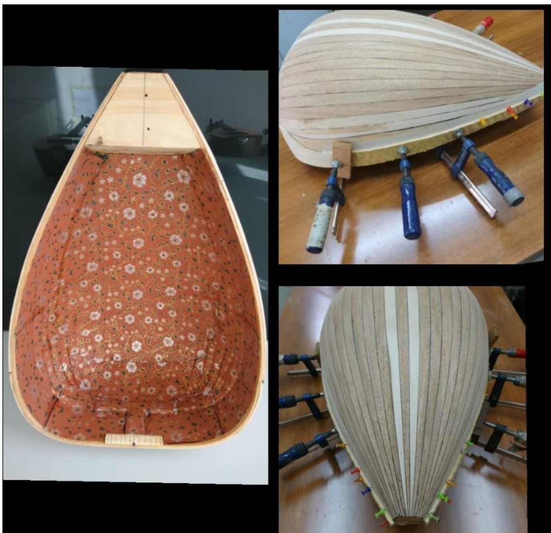
Εικόνα 8 Η κόλληση των πλαϊνών μερών του σκάφους. 46
