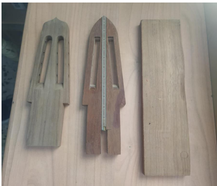
Εικόνα 13 Καράολα κρητικού λαούτου έτοιμα να κολληθούν με το μπράτσο.
