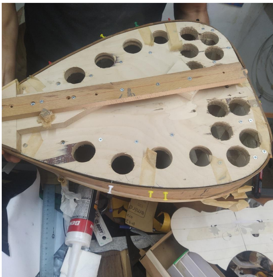
Εικόνα 25 Σκάφος κρητικού λαούτου μέσα στο καλούπι. Οργανοποιείο Παύλου Κανιαδάκη. Αθήνα Ιούνιος 2024
