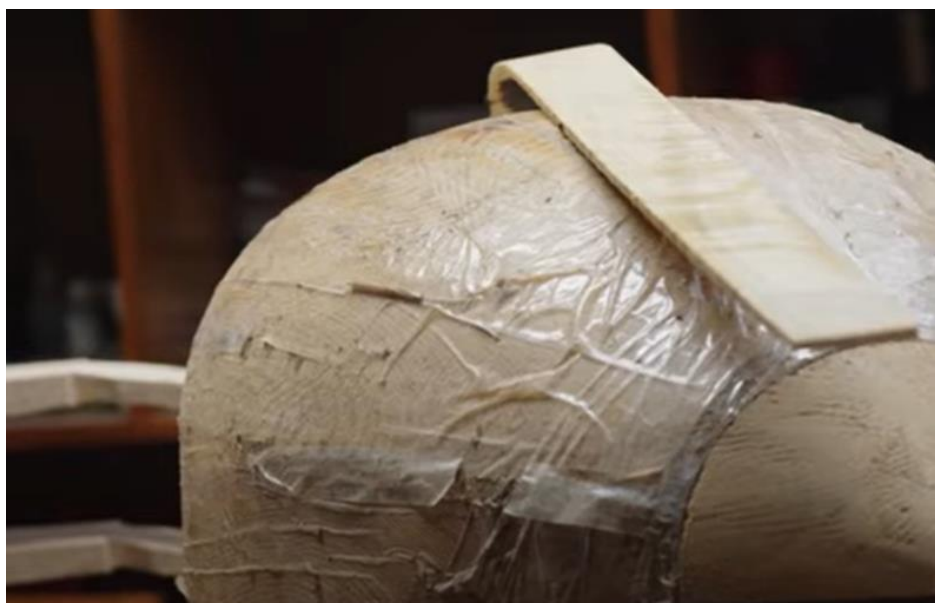
Εικόνα 6 Η τοποθέτηση των ντουγών επάνω στο καλούπι. 44
