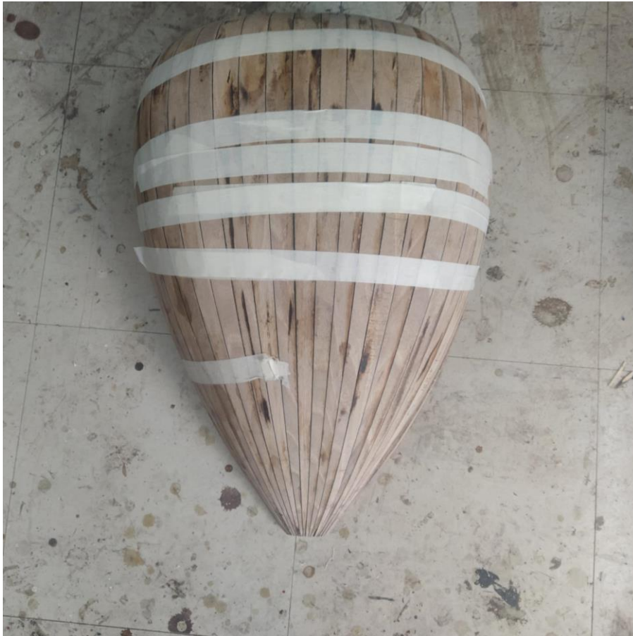
Εικόνα 7 Οι ντούγιες έχουν τοποθετηθεί στο καλούπι και σταθεροποιούνται μέχρι να στεγνώσει η κόλλα. Εργαστήριο Παύλου Κανιαδάκη, Αθήνα 2024. 45
