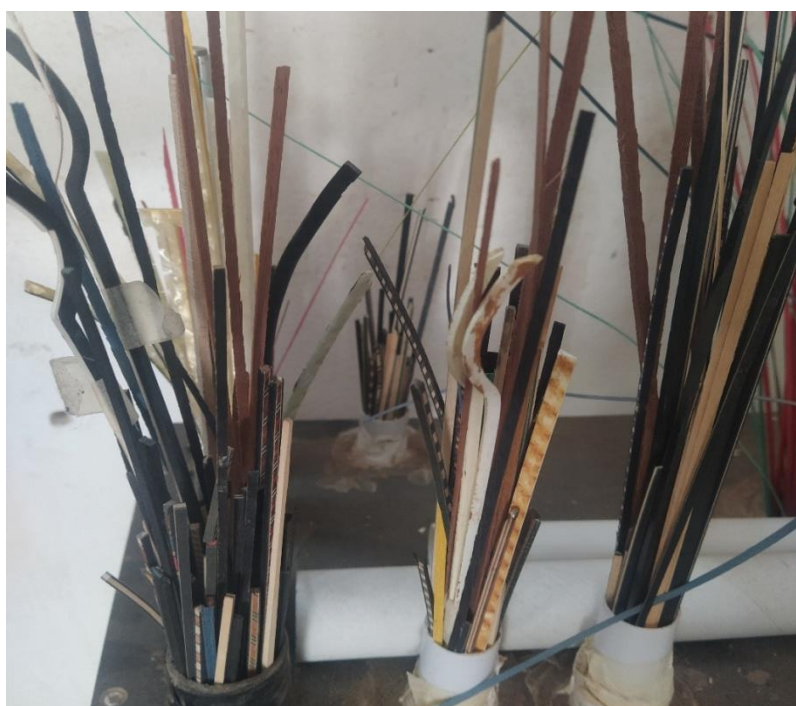
Εικόνα 10 Ξύλινα "φιλέτα" που χρησιμοποιούνται για την διακόσμηση του λαούτου. Οργανοποιείο Παύλου Κανιαδάκη. Αθήνα, Ιούνιος 2024.
