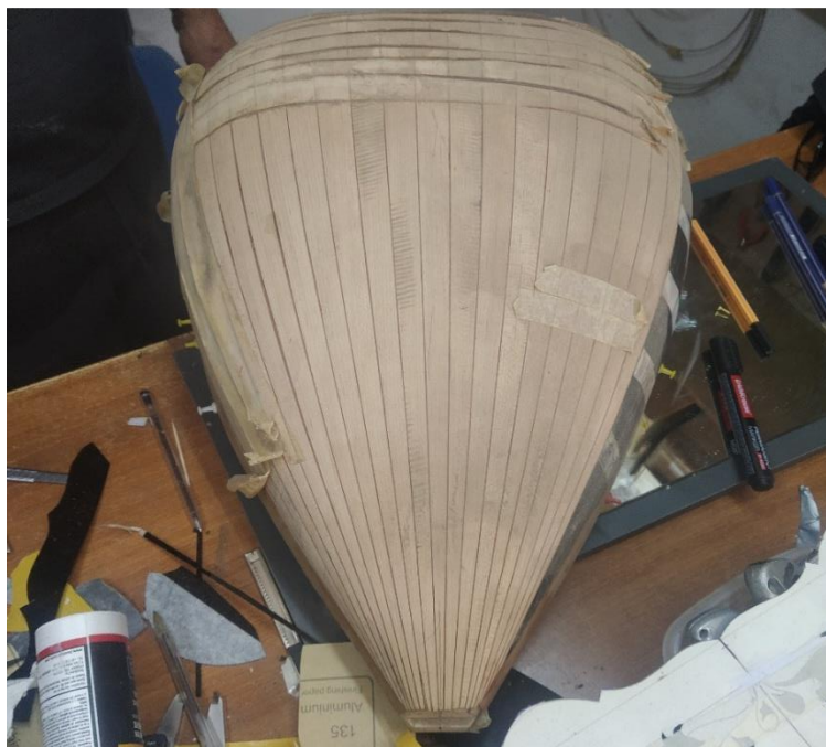
Εικόνα 26 Το σκάφος του κρητικού λαούτου έτοιμο, μόλις αφαιρέθηκε από το καλούπι. Οργανοποιείο Παύλου Κανιαδάκη. Αθήνα Ιούνιος 2024
