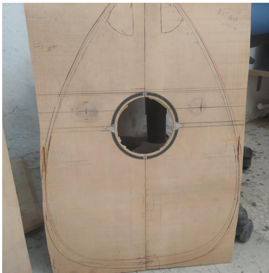
Εικόνα 11 Η τρύπα του καπακιού έχει ανοιχτεί και αφού κοπεί περιμετρικά και τοποθετηθούν τα στολίδια, το καπάκι θα είναι έτοιμο. Οργανοποιείο Παύλου Κανιαδάκη. Αθήνα, Ιούνιος 2024.
