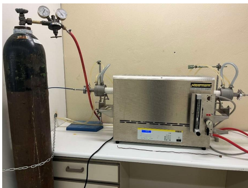
Εικόνα 21. Σωληνοειδής φούρνος B-180, Nabertherm συνδεδεμένος σε παροχή αζώτου.
