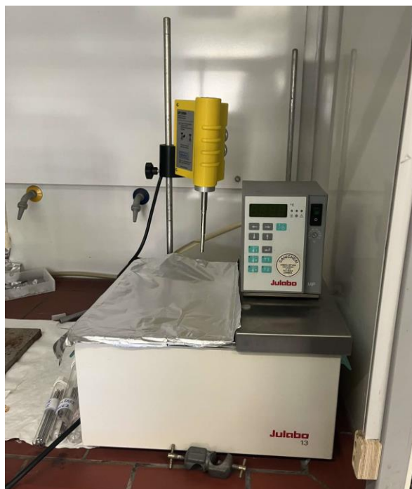
Εικόνα 20. Σύστημα υπερήχων UP-100H, Hielscher με υδατόλουτρο Julabo.
