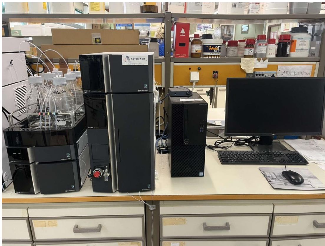
Εικόνα 29. Σύστημα HPLC της εταιρείας Shimadzu εξοπλισμένο με ανιχνευτή διόδων SPD-M40
