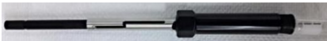
Εικόνα 9: Συσκευή SPME (Agilent technologies) με ίνα SPME
