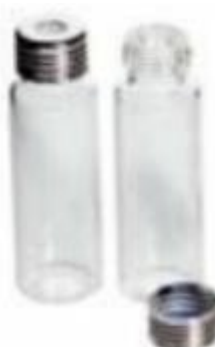
Εικόνα 8: Φιαλίδια (Vials): με πώμα διάτρητο και παρέμβυσμα από τεφλόν
