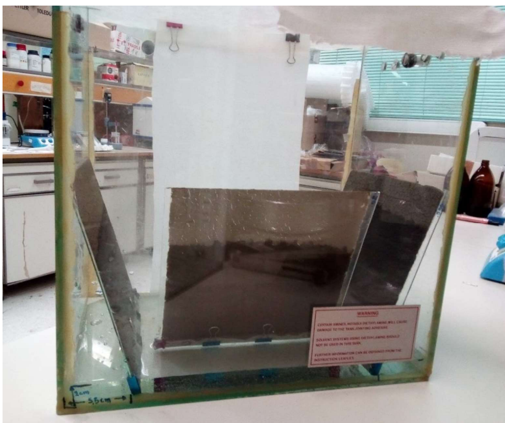
Εικόνα 3.5: Γυάλινος θάλαμος έκλυσης των εδαφικών πλακών.
