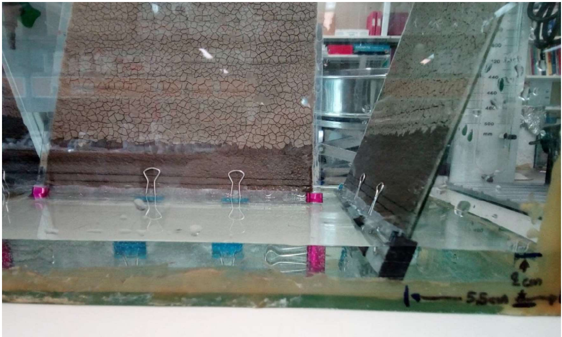
Εικόνα 3.8: Συνθήκες έκλωσης εδαφικών πλακών TLC, στάθμη διαλύτη (νερού), κλίση πλακών και τριχοειδής μεταφορά σε εμβολιασμένες πλάκες λεπτής στιβάδας.
