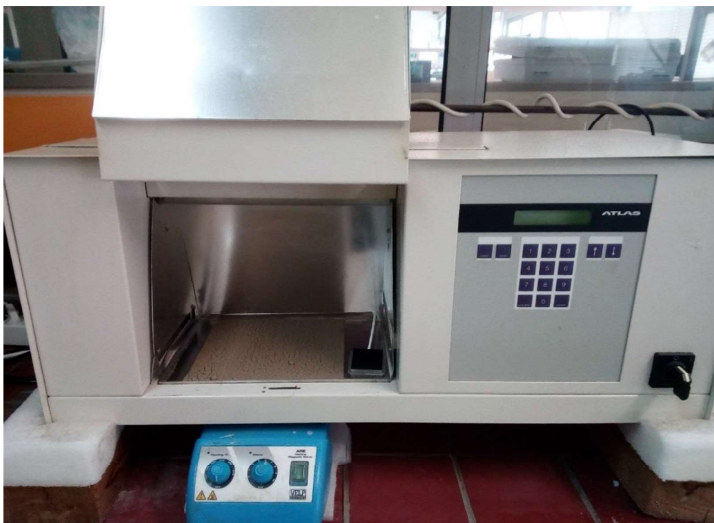
Εικόνα 3.2: Προσομοιωτής ηλιακής ακτινοβολίας SUNTEST CPS+ της εταιρίας Atlas με δείγμα εδάφους σε πλάκα λεπτής στιβάδας TLC.
