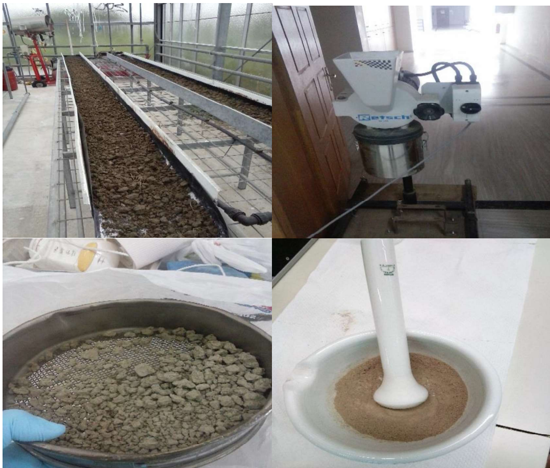
Εικόνα 3.1: Διαδικασία ξήρανσης, κοσκίνισης και λειοτρίβισης εδαφικών δειγμάτων.
