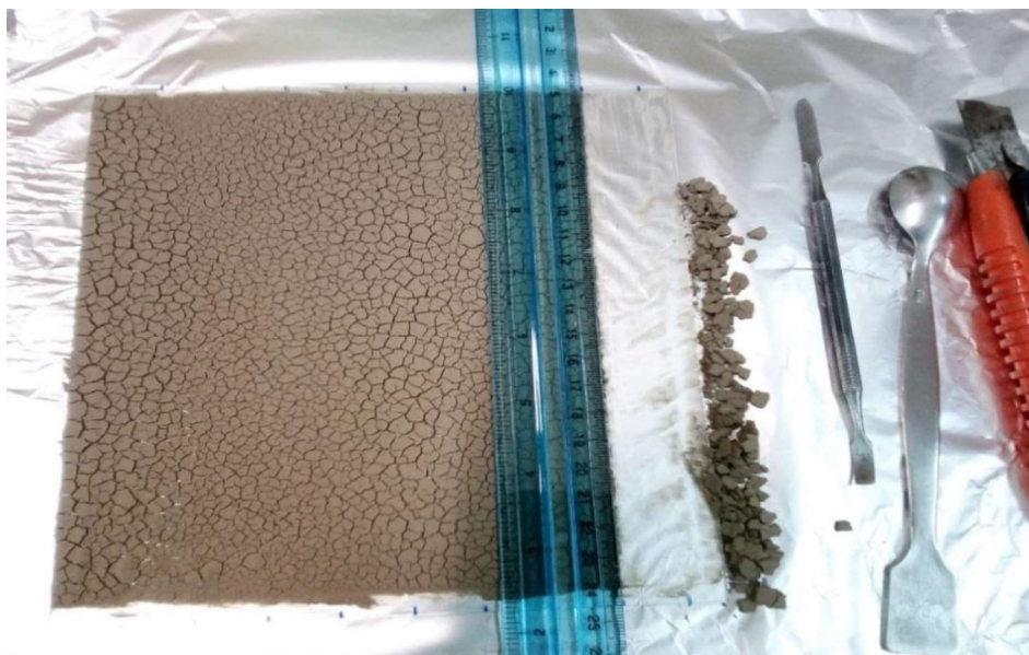
Εικόνα 3.4: Απόξυση δείγματος εδάφους πλάτους 2 cm μετά το πέρας δύο ωρών ακτινοβολήσης σε προσομοιωτή ηλιακής ακτινοβολίας SUNTEST CPS+.
