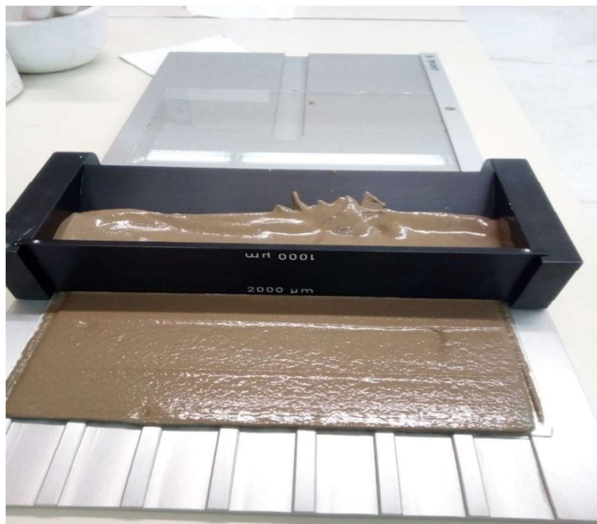
Εικόνα 3.3: Επίστρωση πλάκας λεπτής στιβάδας εδάφους πάχους 2 mm με την συσκευή επίστρωσης πλακών χρωματογραφίας λεπτής στιβάδας (TLC plate coater) της εταιρίας Camag.
