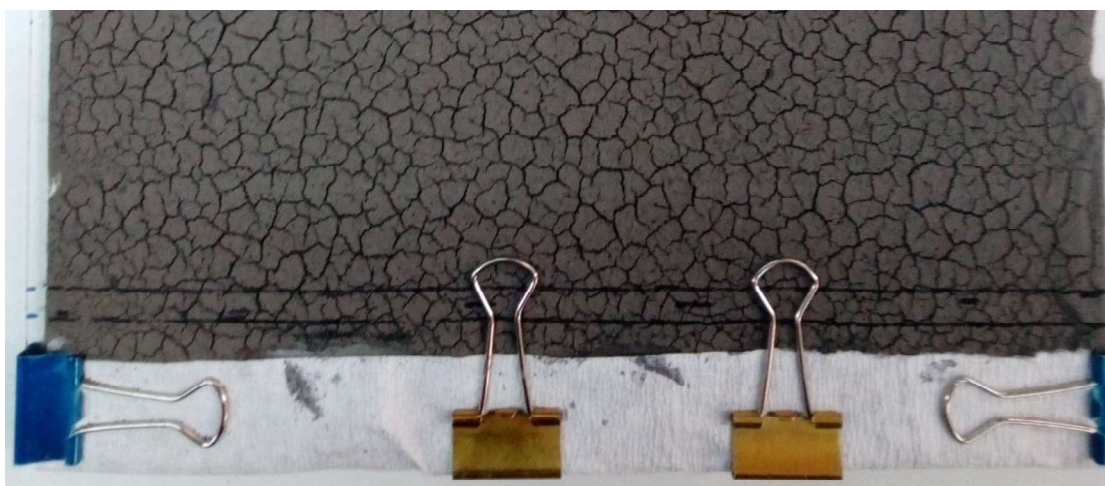
Εικόνα 3.6: Ζώνη εμβολιασμού ζιζανιοκτόνων σε πλάκα TLC και η τεχνική που χρησιμοποιήθηκε για την συγκράτηση του εδάφους και την ομοιόμορφη ροή του διαλύτη (δημιουργία ζώνης με ακινητοποιημένο διηθητικό χαρτί σε επαφή με την εδαφική στιβάδα).
