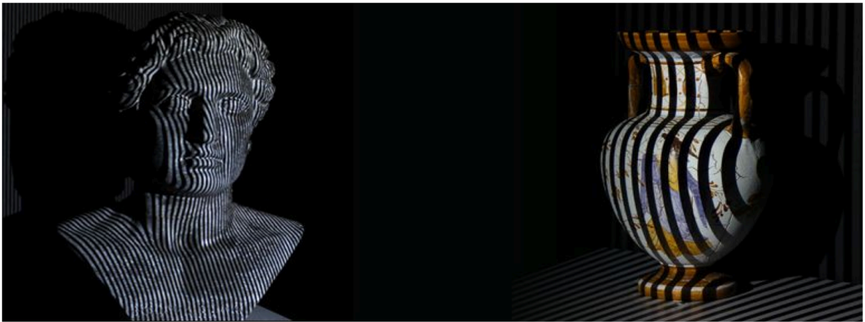
(Εικόνα 1.5) - Το μοτίβο φωτός ενός 3D scanner με βάση την τεχνική structured light πάνω σε δύο αντικείμενα. (Πηγή: 3DUNDERWORLD-SLS: An Open-Source Structured-Light Scanning System for Rapid Geometry Acquisition)
