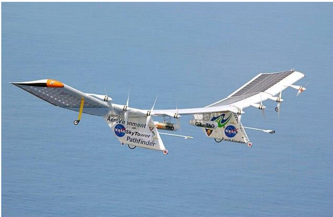
Εικόνα 2 ΜΕΑΣ – Μη επανδρωμένο αεροχέμα σε μορφή πτέρυγας
