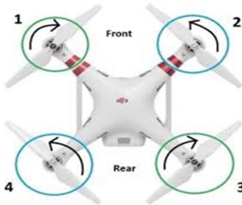
Εικόνα 10 περιστροφή ελίκων σε ένα τετρακόπτερο
