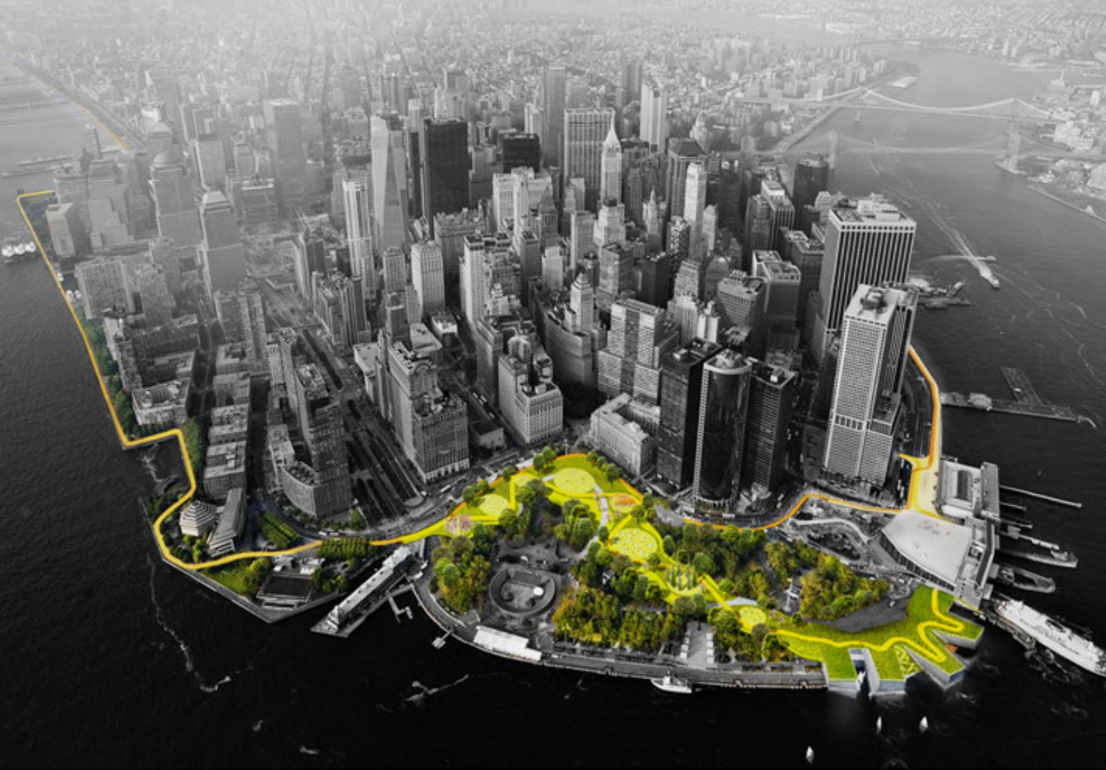
Εικόνα 81: Άποψη του σχεδιαστικού οράματος για το “The Big U” κατά μήκος της νοτιοανατολικής ακτογραμμής του Μανχάταν. Το έργο συνδυάζει υποδομές αντιπλημμυρικής προστασίας με πράσινες διαδρομές και δημόσιους χώρους, οργανώνοντας την αστική ανθεκτικότητα μέσω τοπικών παρεμβάσεων πολλαπλής χρήσης.
