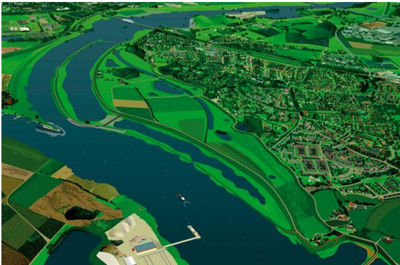
Εικόνα 53: Ψηφιακή αναπαράσταση της περιοχής Lent στη Νιμέγη, όπου εφαρμόστηκε μία από τις χαρακτηριστικές παρεμβάσεις του προγράμματος Room for the River: η δημιουργία παράλληλης κοίτης και τεχνητής νησίδας. Η στρατηγική αυτή συνδυάζει τη βελτίωση της υδραυλικής απόδοσης με τον σχεδιασμό ενός νέου αστικού τοπίου, ενσωματώνοντας τον ποταμό ως ενεργό δημόσιο χώρο και όχι ως απειλή.
