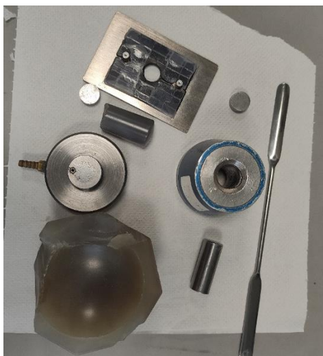
Εικόνα 22. Γουδί αχάτη (κάτω αριστερά) καλούπια (μέση) λαβίδα (δεξιά) διεγματοφορέας (πάνω)
