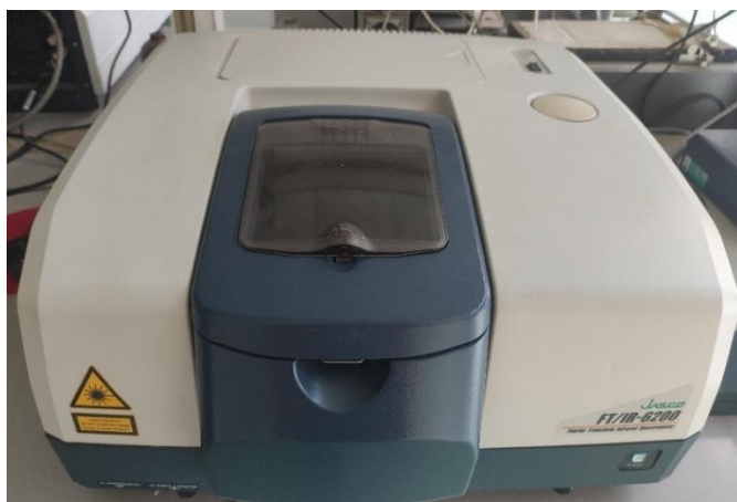
Εικόνα 26. Φασματόμετρο Jasco FT-IR-6200
