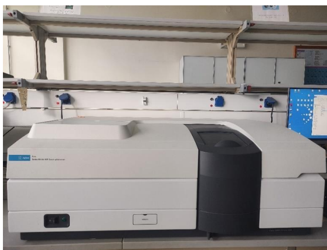
Εικόνα 16. Φασματόμετρο Cary 5000 UV-Vis-NIR
