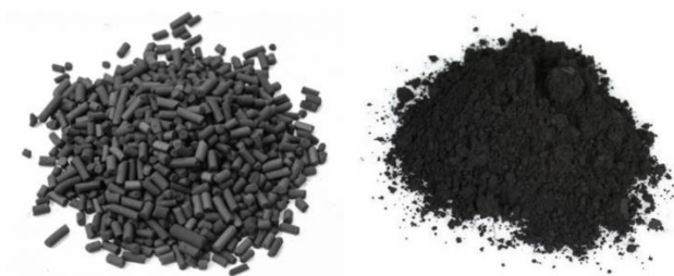
Εικόνα 17. Ενεργός άνθρακας σε κυλινδρικά έκβολα (αριστερά) και σε σκόνη (δεξιά)
