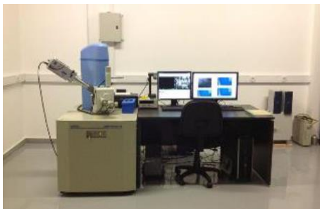
Εικόνα 28. Ηλεκτρονικό Μικροσκόπιο Σάρωσης με φασματόμετρο ενεργειακής διασποράς ακτίνων X της εταιρείας JEOL.
