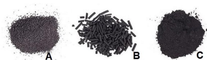
Εικόνα 4. Ενεργός Άνθρακας σε μορφή Κόκκων Α, Κυλίνδρων Β, Σκόνης C [33]
