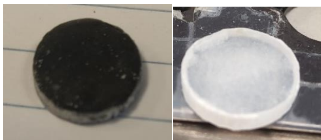
Εικόνα 25. Παλλέτα ενεργού άνθρακα με KBr (αριστερά) και σκέτου KBr (δεξιά)
