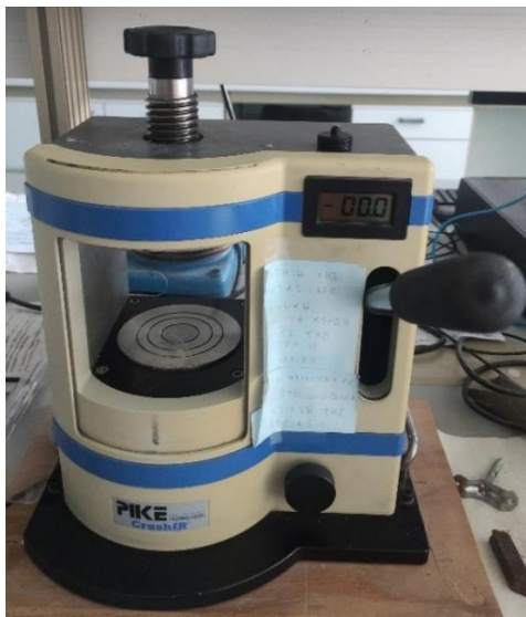
Εικόνα 23. Υδραυλική Πρέσσα της εταιρείας Pike
