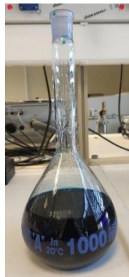
Εικόνα 15. Διάλυμα Ι Μπλε του Μεθυλενίου (MB) 100 ppm
