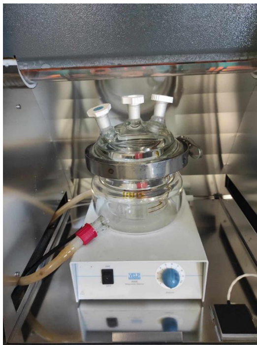
Εικόνα 6.2: Θάλαμος ακτινοβολήσης με εγκατεστημένο τον αντιδραστήρα Duran, επί του μαγνητικού αναδευτήρα.
