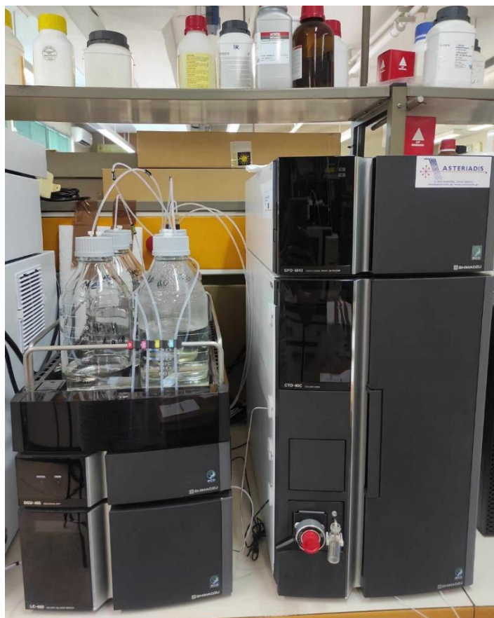
Εικόνα 6.5: Σύστημα Υγρής Χρωματογραφίας Υψηλής Απόδοσης (HPLC), της εταιρείας Shimadzu (Kyoto, Japan).
