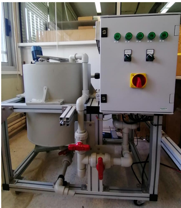
Εικόνα 6.4: Φωτογραφία του πιλοτικού αντιδραστήρα εργαστηριακής κλίμακας, όπου φαίνονται ο αντιδραστήρας και η δεξαμενή ανακυκλοφορίας.
