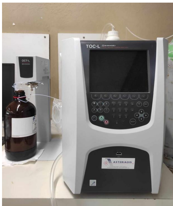
Εικόνα 6.9: Αυτόματος αναλυτής ολικού οργανικού άνθρακα TOC-L analyzer του οίκου Shimadzu (Kyoto, Japan).
