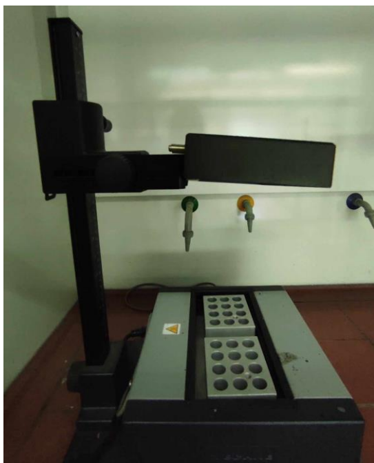
Εικόνα 6.12: Συσκευή συμπύκνωσης 24 θέσεων του οίκου Techne (Staffordshire, United Kingdom).
