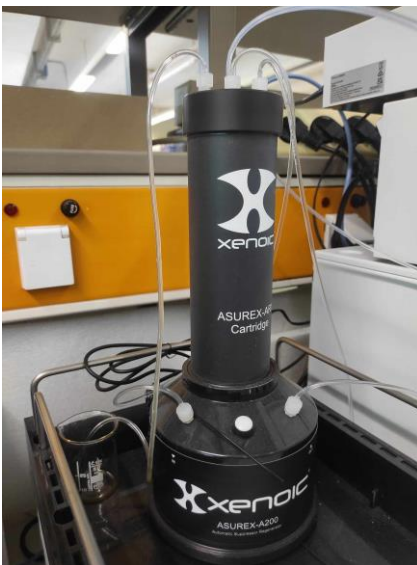
Εικόνα 6.7: Σύστημα καταστολής (Suppressor, Xenoic).
