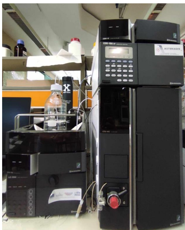
Εικόνα 6.6: Σύστημα Ιοντικής Χρωματογραφίας (IC), που χρησιμοποιήθηκε για τον προσδιορισμό της συγκέντρωσης των \text{NO}_2^- και \text{NO}_3^- .
