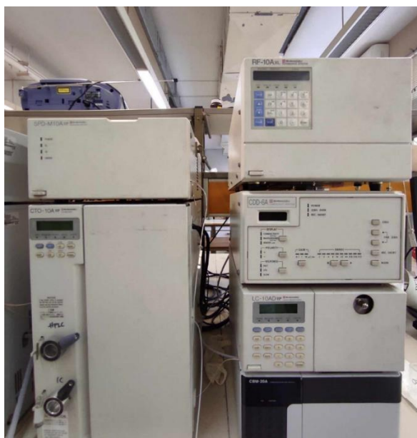
Εικόνα 6.8: Σύστημα Ιοντικής Χρωματογραφίας (IC), που χρησιμοποιήθηκε για τον προσδιορισμό της συγκέντρωσης των \text{NH}_4^+ .
