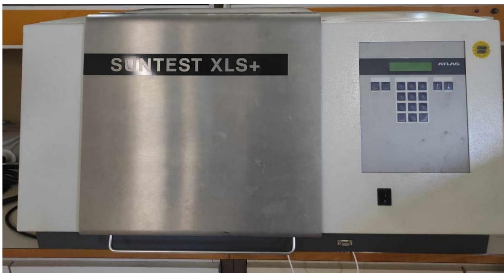
Εικόνα 6.1: Προσομοιωτής ηλιακής ακτινοβολίας SUNTEST XLS+, της εταιρείας Atlas.
