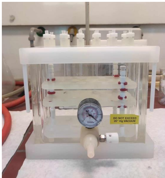
Εικόνα 6.11: Συσκευή εκχύλισης 12 θέσεων Visiprep DL του οίκου Supelco (Bellefonte, PA, USA), συνδεδεμένη με αντλία κενού του οίκου Laboport (Oxfordshire, United Kingdom).
