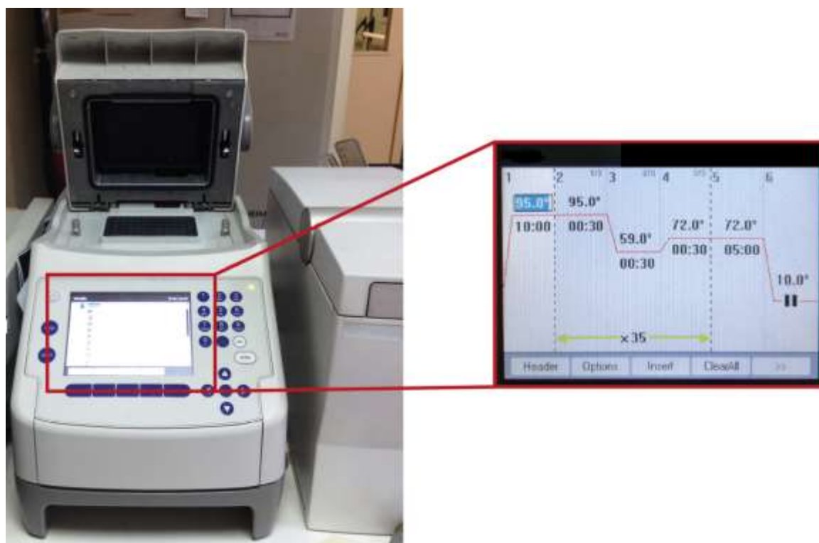
Σχήμα 1.9: Θερμικός κυκλοποιητής όπου πραγματοποιείται η κλασική αντίδραση PCR. Στην οθόνη του μηχανήματος απεικονίζεται το πρόγραμμα των διαδοχικών κύκλων για τη διενέργεια της αντίδρασης.
