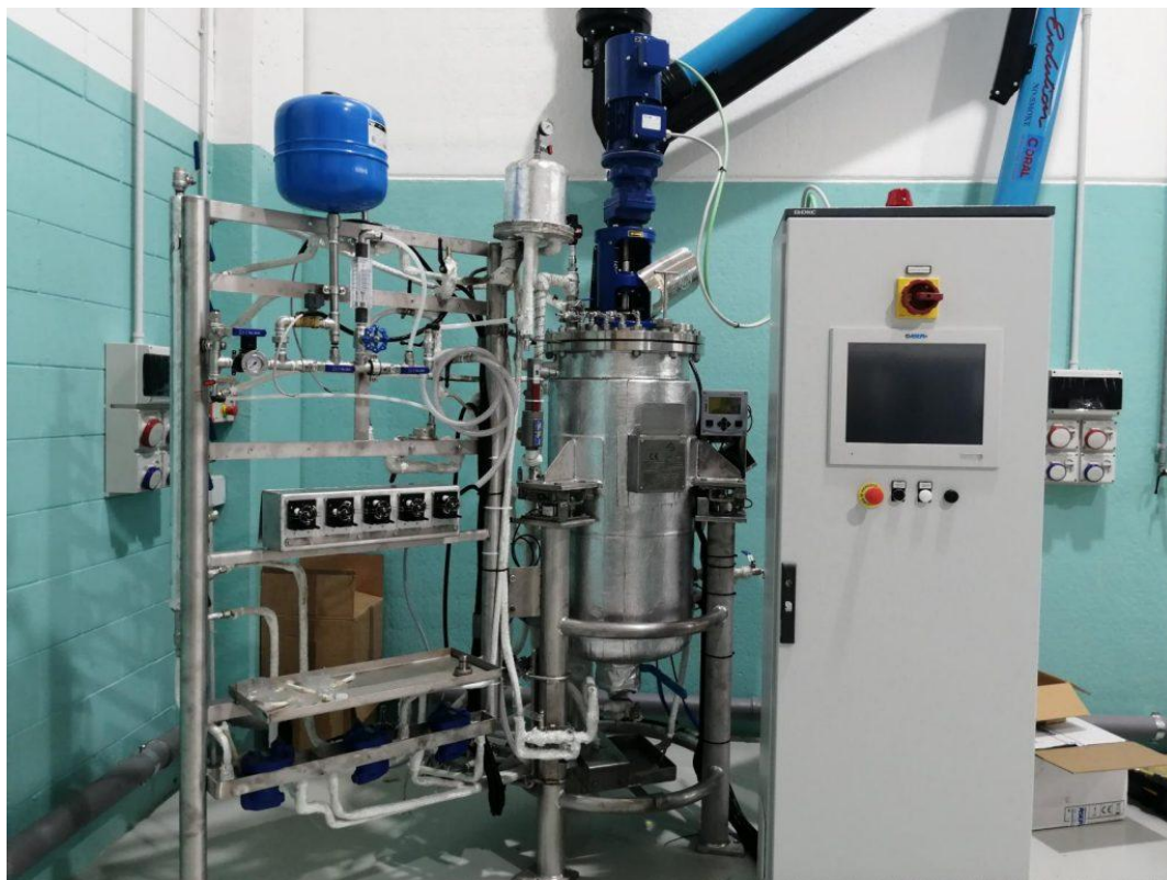
Εικόνα 9.: Βιοαντιδραστήρας βυθισμένης ζύμωσης ( www.gibobsrl.com/biotech-plants/bioreactors-smf )
