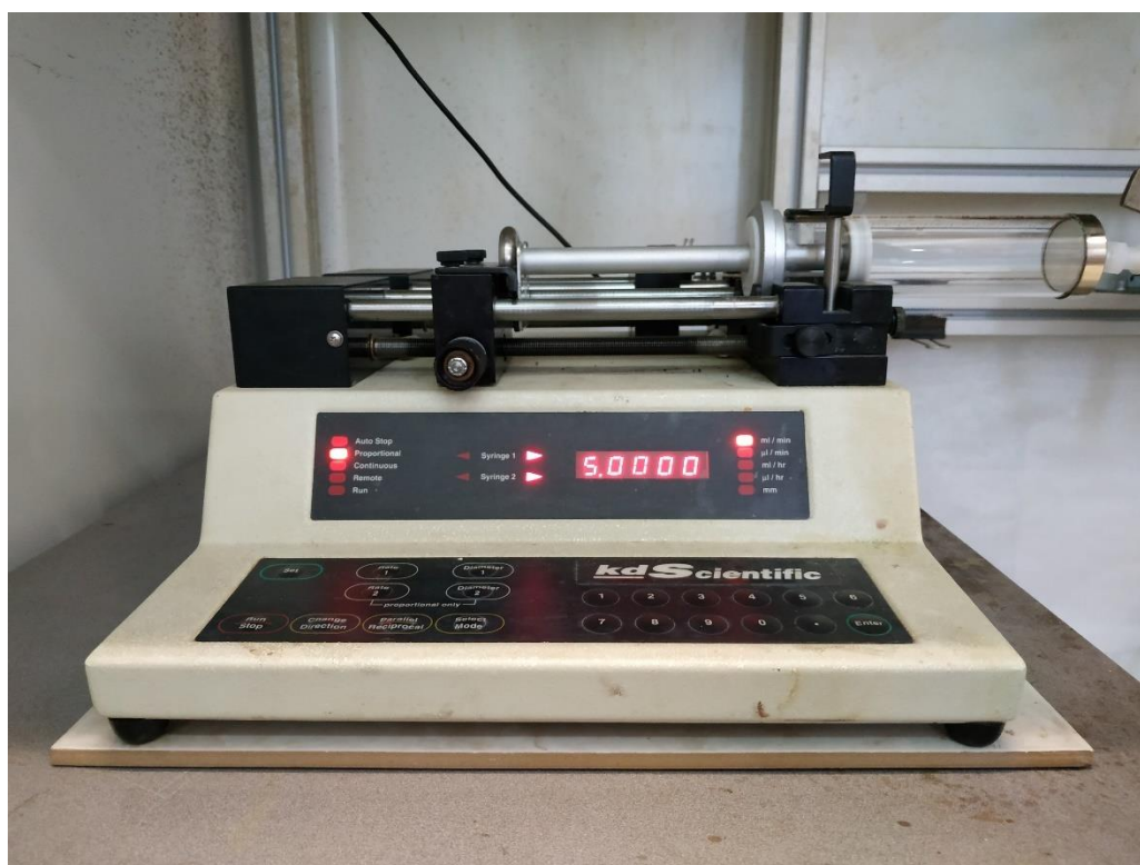
Εικόνα 3.23 Αντλία σύριγγας που χρησιμοποιείται για τον ψεκασμό
