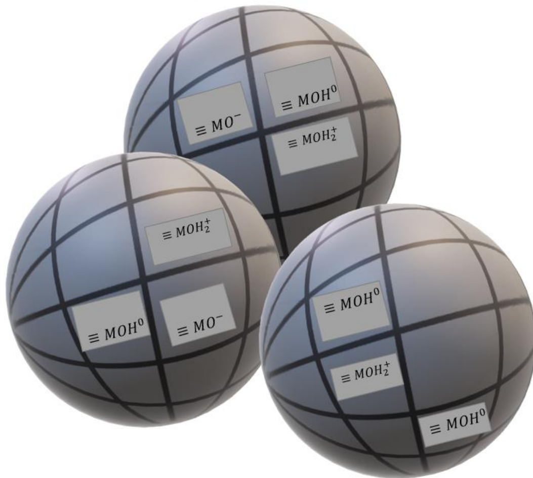
Εικόνα 1.3 Σχηματική αναπαράσταση των επιφανειακών υδροξυλομάδων [≡\text{MOH}_2^+] , [≡\text{MO}^-] και [≡\text{MOH}^0] για σωματίδια νανοοξειδίου
