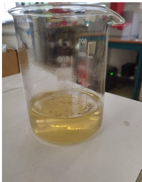
Εικόνα 4.37 Το υλικό FSP-#3788 διασπειρόμενο σε υδατικό διάλυμα. Η ύπαρξη οργανικών ουσιών δεν επιτρέπει την διασπορά
