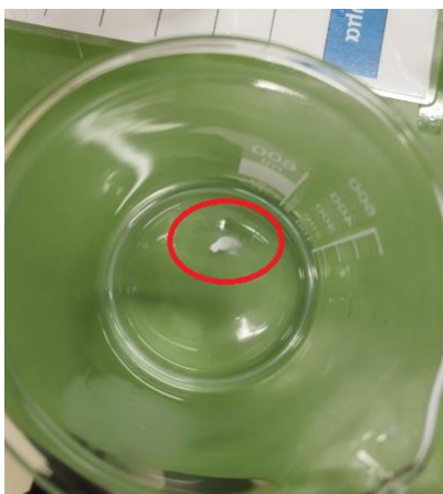
Εικόνα 3.16 Συσσωμάτωση σωματιδίων σε ένα σωματιδίου του ποτηριού. Πρέπει να μετακινηθεί ο αναδευτήρας για να εξασφαλίζεται καλή διασπορά στο διάλυμα
