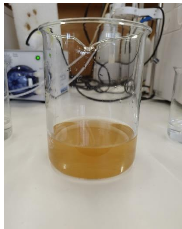
Εικόνα 4.41 α) Τίτλοδοτήσεις του FSP-#3874 με διαφορετικές διεργασίες (treatments) για μέτρηση του Ζήτα δυναμικού. Τίτλοδοτηση από βασικές προς όξινες τιμές pH για το υλικό as prepared, calcined 2h 400C, 1 ethanol wash. β) Τίτλοδοτηση από βασικές προς όξινες τιμές pH για το υλικό as prepared, calcined 2h 400C, 1 ethanol wash έπειτα από ενυδάτωση 12 ωρών
