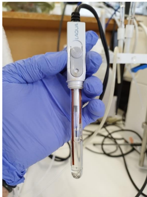
Εικόνα 3.7 Ηλεκτρόδιο που χρησιμοποιείται για μέτρηση του pH του διαλύματος.
