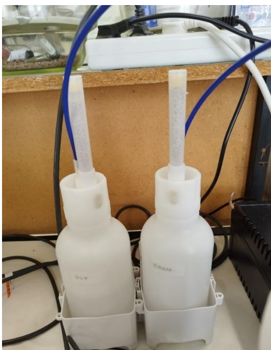
Εικόνα 3.6 Προχοϊδες οξέος και βάσης του τιτλοδότη LY-711
