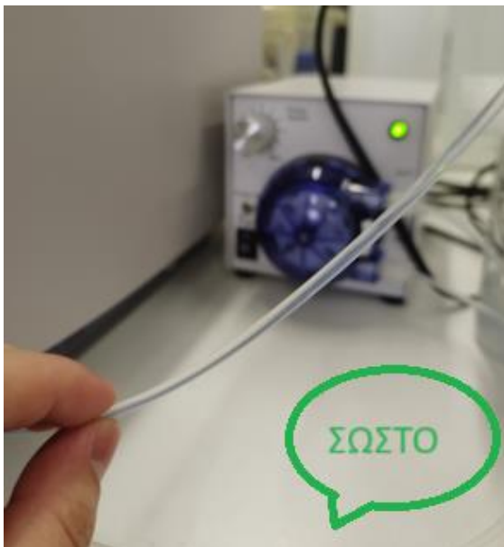
Εικόνα 3.13 Παράδειγμα σωστής ροής κυκλώματος όπου δεν δημιουργούνται φυσαλίδες.
