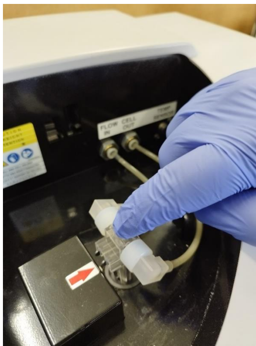
Εικόνα 3.3 Τοποθέτηση της κυψελίδας στην θέση μέτρησης του οργάνου
