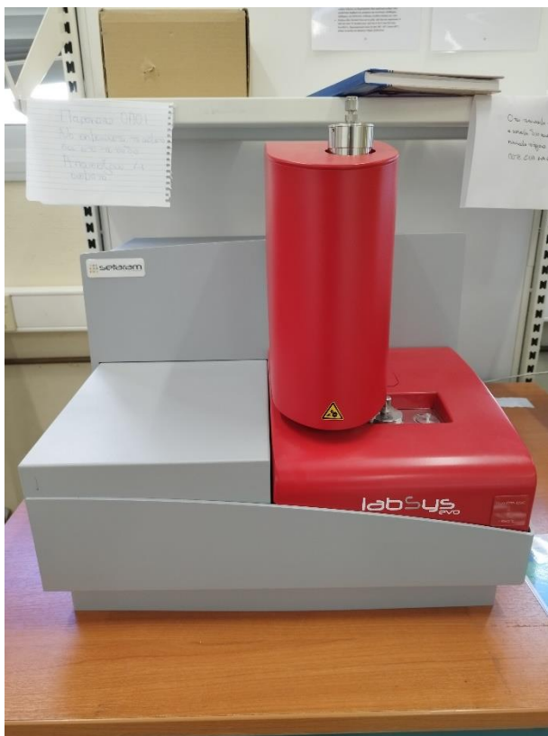
Εικόνα 3.30 Πειραματική διάταξη θερμοβαρυτικών μετρήσεων TG/DTA
