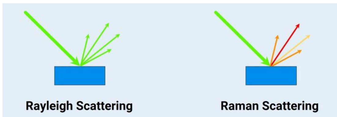
Εικόνα 13. Απεικόνιση ελαστικής (Rayleigh) και ανελαστικής (Raman) σκέδασης φωτός κατά την αλληλεπίδραση με δείγμα. 33
