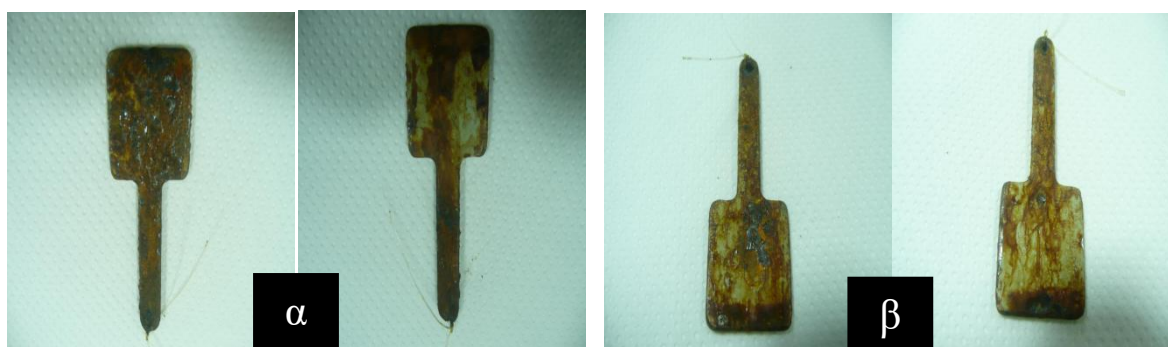
Εικόνα 5.33: Σύγκριση του δείγματος 1 (εικόνα α) St37 dcp χωρίς διαμόρφωση στους 1000°C, χωρίς αμμοβολή με επικάλυψη Μίνιο και του δείγματος 1* (εικόνα β) St37 dcp χωρίς διαμόρφωση στους 1000°C, χωρίς αμμοβολή και με επικάλυψη Gridox στις 20 ημέρες παραμονής στο θάλαμο αλατονέφωσης. (Στα αριστερά κάθε εικόνας είναι με προ-χαραγή και δεξιά χωρίς χαραγή)
