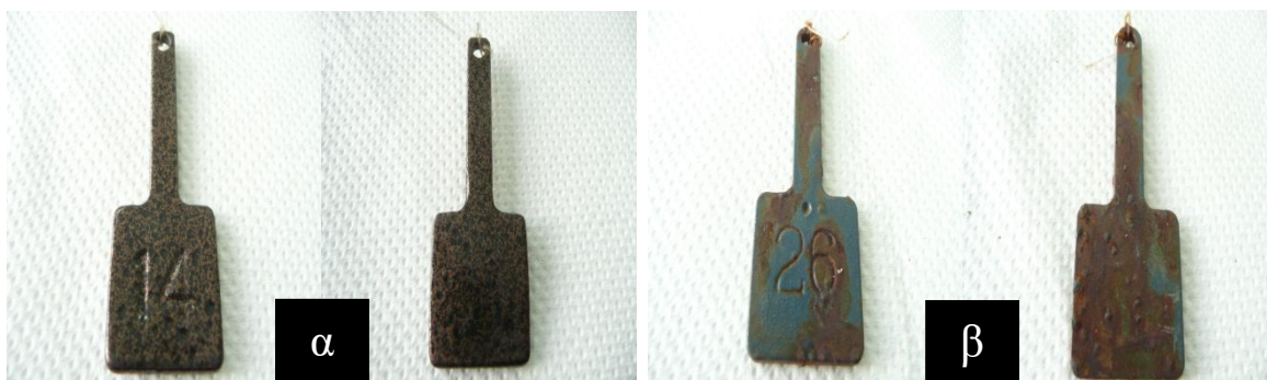
Εικόνα 5.49: Σύγκριση του δείγματος 14 (εικόνα α) Stainless Steel 304 χωρίς διαμόρφωση στους 1000°C, με αμμοβολή και με ηλεκτροστατική ψευδαργύρωση και ηλεκτροστατική σφυρήλατη και του δείγματος 26* (εικόνα β) Stainless Steel 304 χωρίς διαμόρφωση στους 1000°C, με αμμοβολή και με ηλεκτροστατική ψευδαργύρωση και ηλεκτροστατική σφυρήλατη για τις 100 και 76 ημέρες αντίστοιχα παραμονής τους στο θάλαμο αλατονέφωσης. (Στα αριστερά κάθε εικόνας είναι με προ-χαραγή και δεξιά χωρίς χαραγή)
