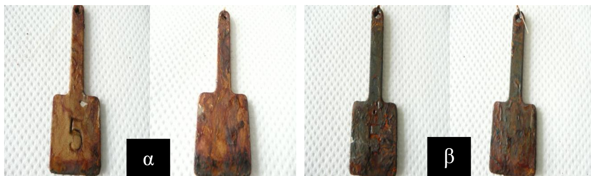
Εικόνα 5.37: Σύγκριση του δείγματος 5 (εικόνα α) St37 dcp χωρίς διαμόρφωση στους 1000°C, με αμμοβολή με επικάλυψη Gridox και Alcea και του δείγματος 5* (εικόνα β) St37 dcp χωρίς διαμόρφωση στους 1000°C, με αμμοβολή και με επικάλυψη Gridox και Paramatti στις 75 ημέρες παραμονής στο θάλαμο αλατονέφωσης. (Στα αριστερά κάθε εικόνας είναι με προ-χαραγή και δεξιά χωρίς χαραγή)
