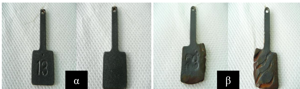
Εικόνα 5.62: Σύγκριση δείγματος 13* (εικόνα α) Stainless Steel 304 χωρίς διαμόρφωση στους 1000°C, με αμμοβολή με επικάλυψη Gridox και Paramatti και του δείγματος 23 (εικόνα β) Stainless Steel 304 με διαμόρφωση στους 1000°C, με αμμοβολή με επικάλυψη Gridox και Paramatti στις 100 ημέρες παραμονής στο θάλαμο αλατονέφωσης. (Στα αριστερά κάθε εικόνας είναι με προ-χαραγή και δεξιά χωρίς χαραγή)
