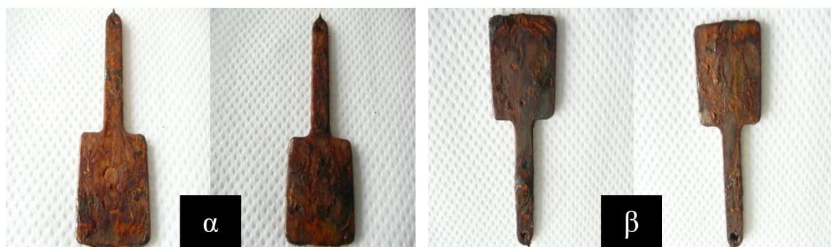
Εικόνα 5.35: Σύγκριση του δείγματος 3 (εικόνα α) St37 dcp χωρίς διαμόρφωση στους 1000°C, χωρίς αμμοβολή με επικάλυψη Gridox και Alcea και του δείγματος 3* (εικόνα β) St37 dcp χωρίς διαμόρφωση στους 1000°C, χωρίς αμμοβολή και με επικάλυψη Gridox και Paramatti στις 75 ημέρες παραμονής στο θάλαμο αλατονέφωσης. (Στα αριστερά κάθε εικόνας είναι με προ-χαραγή και δεξιά χωρίς χαραγή)
