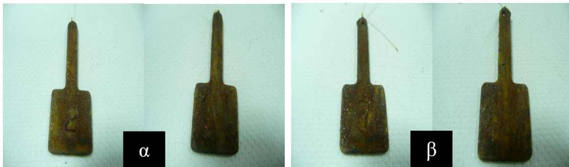
Εικόνα 5.60: Σύγκριση δείγματος 2 (εικόνα α) St37 dcp χωρίς διαμόρφωση στους 1000°C, χωρίς αμμοβολή με επικάλυψη Alcea και του δείγματος 7 (εικόνα β) St37 dcp χωρίς διαμόρφωση στους 1000°C, με αμμοβολή με επικάλυψη Alcea στις 20 ημέρες παραμονής στο θάλαμο αλατονέφωσης. (Στα αριστερά κάθε εικόνας είναι με προ-χαραγή και δεξιά χωρίς χαραγή)
