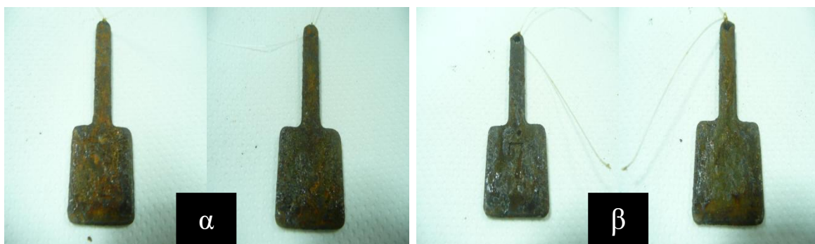
Εικόνα 5.61: Σύγκριση δείγματος 2* (εικόνα α) St37 dcp χωρίς διαμόρφωση στους 1000°C, χωρίς αμμοβολή με επικάλυψη Paramatti και του δείγματος 7* (εικόνα β) St37 dcp χωρίς διαμόρφωση στους 1000°C, με αμμοβολή με επικάλυψη Paramatti στις 20 ημέρες παραμονής στο θάλαμο αλατονέφωσης. (Στα αριστερά κάθε εικόνας είναι με προ-χαραγή και δεξιά χωρίς χαραγή)
