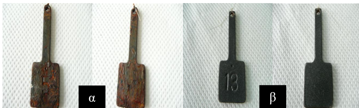
Εικόνα 5.45: Σύγκριση του δείγματος 5* (εικόνα α) St37 dcp χωρίς διαμόρφωση στους 1000°C, με αμμοβολή και με επίστρωση Gridox και Paramatti και του δείγματος 13* (εικόνα β) Stainless Steel 304 χωρίς διαμόρφωση στους 1000°C, με αμμοβολή και με επίστρωση Gridox και Paramatti για τις 75 και 100 ημέρες αντίστοιχα παραμονής τους στο θάλαμο αλατονέφωσης. (Στα αριστερά κάθε εικόνας είναι με προ-χαραγή και δεξιά χωρίς χαραγή)
