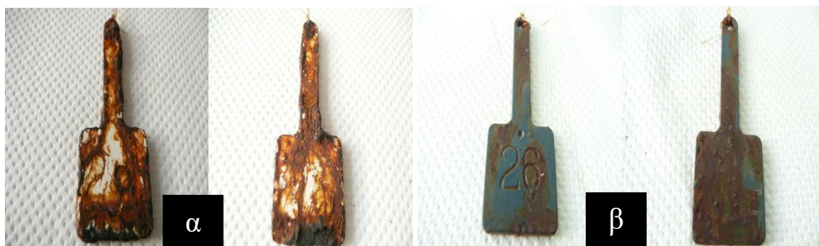
Εικόνα 5.44: Σύγκριση του δείγματος 26 (εικόνα α) Stainless Steel 304 χωρίς διαμόρφωση στους 1000°C, χωρίς αμμοβολή και με ηλεκτροστατική σφυρήλατη και του δείγματος 26* (εικόνα β) Stainless Steel 304 χωρίς διαμόρφωση στους 1000°C, χωρίς αμμοβολή και με ηλεκτροστατική ψευδαργύρωση και ηλεκτροστατική σφυρήλατη στις 100 ημέρες παραμονής στο θάλαμο αλατονέφωσης. (Στα αριστερά κάθε εικόνας είναι με προ-χαραγή και δεξιά χωρίς χαραγή)
