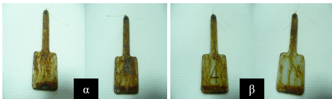
Εικόνα 5.57: Σύγκριση του δείγματος 1* (εικόνα α) St37 χωρίς διαμόρφωση στους 1000°C, χωρίς αμμοβολή και με επικάλυψη Gridox και του δείγματος 4* (εικόνα β) St37 χωρίς διαμόρφωση στους 1000°C, με αμμοβολή και με επικάλυψη Gridox στις 20 ημέρες παραμονής στο θάλαμο αλατονέφωσης. (Στα αριστερά κάθε εικόνας είναι με προ-χαραγή και δεξιά χωρίς χαραγή)
