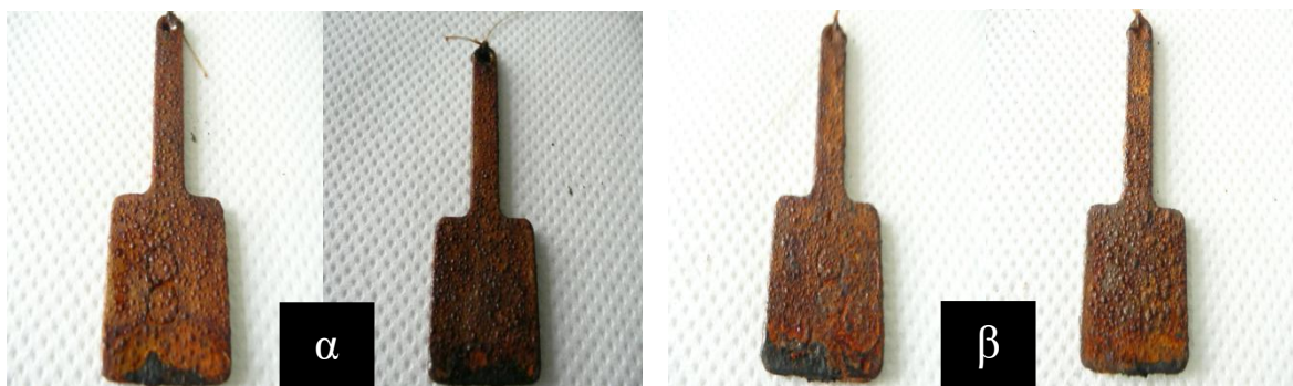
Εικόνα 5.39: Σύγκριση του δείγματος 8 (εικόνα α) St37 dcp χωρίς διαμόρφωση στους 1000°C, με αμμοβολή με επικάλυψη Γομωτής και Alcea και του δείγματος 8* (εικόνα β) St37 dcp χωρίς διαμόρφωση στους 1000°C, με αμμοβολή και με επικάλυψη Γομωτής και Paramatti στις 76 ημέρες παραμονής στο θάλαμο αλατονέφωσης. (Στα αριστερά κάθε εικόνας είναι με προ-χαραγή και δεξιά χωρίς χαραγή)
