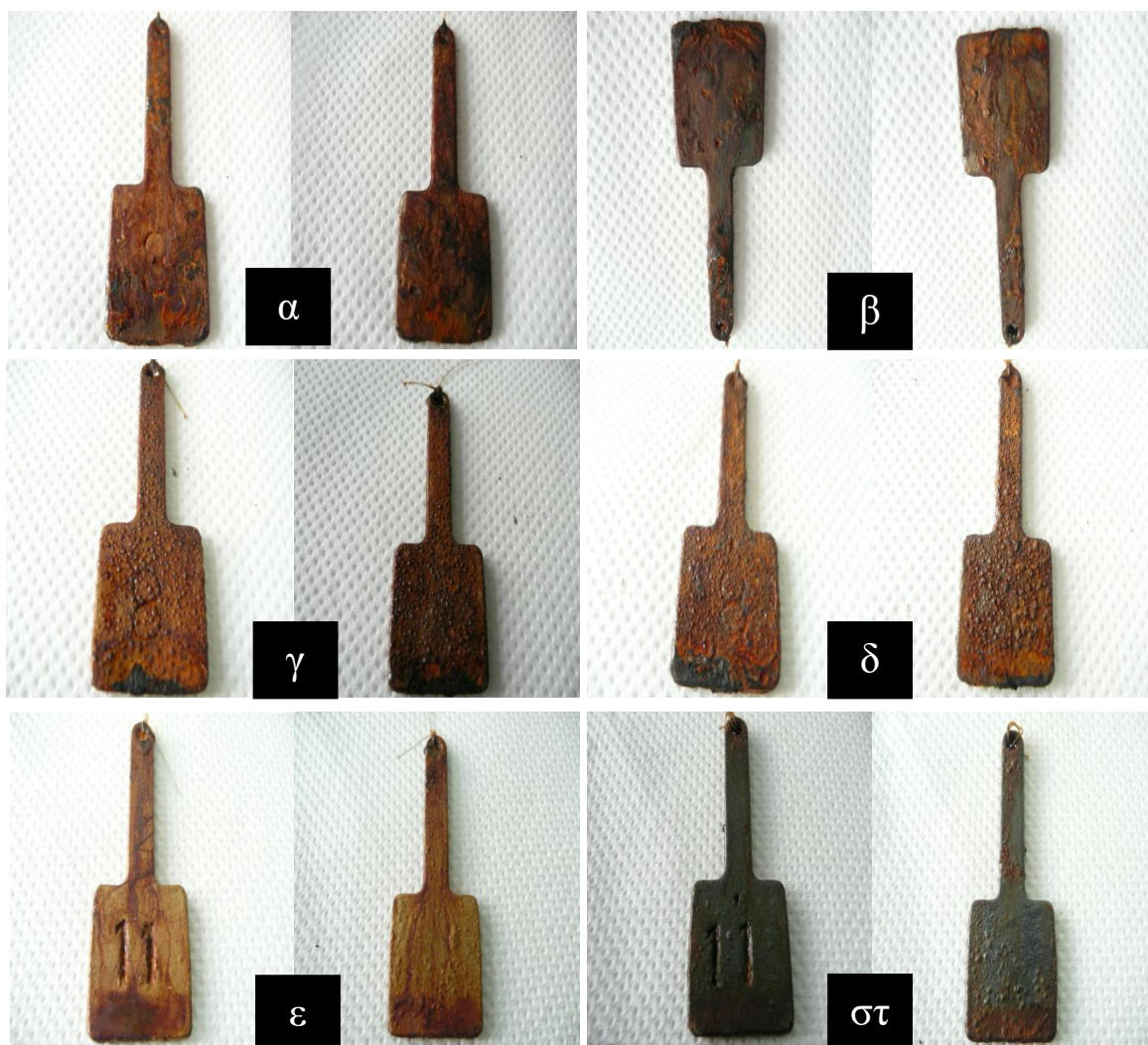
Εικόνα 5.52: Σύγκριση του δείγματος 3 (εικόνα α) St37 dcp χωρίς διαμόρφωση στους 1000°C, χωρίς αμμοβολή με επικάλυψη Gridox και Alcea και του δείγματος 3* (εικόνα β) St37 dcp χωρίς διαμόρφωση στους 1000°C, χωρίς αμμοβολή και με επικάλυψη Gridox και Paramatti στις 75 ημέρες παραμονής στο θάλαμο αλατονέφωσης. Του δείγματος 8 (εικόνα γ) St37 dcp χωρίς διαμόρφωση στους 1000°C, με αμμοβολή με επικάλυψη Γομωτή με Alcea και του δείγματος 8* (εικόνα δ) St37 dcp χωρίς διαμόρφωση στους 1000°C, με αμμοβολή και με επικάλυψη Γομωτής με Paramatti στις 76 ημέρες παραμονής στο θάλαμο αλατονέφωσης. Και του δείγματος 11 (εικόνα ε) St37 dcp χωρίς διαμόρφωση στους 1000°C, με αμμοβολή με επικάλυψη Γομωτή, Gridox και Alcea και του δείγματος 11* (εικόνα στ) St37 dcp χωρίς διαμόρφωση στους 1000°C, με αμμοβολή και με επικάλυψη Γομωτή, Gridox και Paramatti στις 87 ημέρες παραμονής στο θάλαμο αλατονέφωσης. . (Στα αριστερά κάθε εικόνας είναι με προ-χαραγή και δεξιά χωρίς χαραγή)
