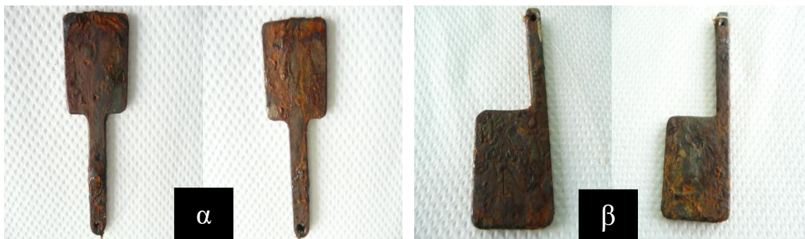
Εικόνα 5.46: Σύγκριση του δείγματος 3* (εικόνα α) St37 dcp χωρίς διαμόρφωση στους 1000°C, χωρίς αμμοβολή και με επίστρωση Gridox και Paramatti και του δείγματος 22 (εικόνα β) St37 με καλαμίνη χωρίς διαμόρφωση στους 1000°C, χωρίς αμμοβολή και με επίστρωση Gridox και Paramatti για τις 75 και 67 ημέρες αντίστοιχα παραμονής τους στο θάλαμο αλατονέφωσης. (Στα αριστερά κάθε εικόνας είναι με προ-χαραγή και δεξιά χωρίς χαραγή)
