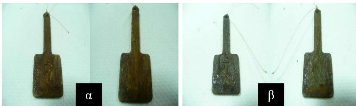
Εικόνα 5.38: Σύγκριση του δείγματος 7 (εικόνα α) St37 dcp χωρίς διαμόρφωση στους 1000°C, με αμμοβολή με επικάλυψη Alcea και του δείγματος 7* (εικόνα β) St37 dcp χωρίς διαμόρφωση στους 1000°C, με αμμοβολή και με επικάλυψη Paramatti στις 21 ημέρες παραμονής στο θάλαμο αλατονέφωσης. (Στα αριστερά κάθε εικόνας είναι με προ-χαραγή και δεξιά χωρίς χαραγή)
