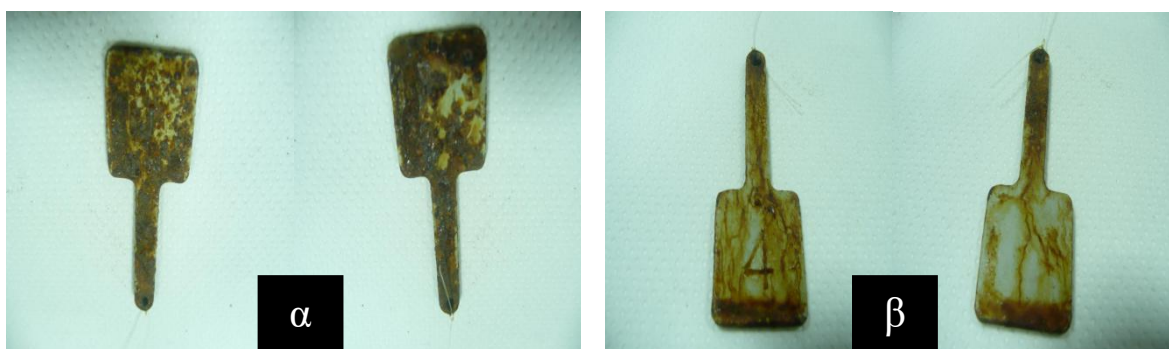
Εικόνα 5.36: Σύγκριση του δείγματος 4 (εικόνα α) St37 dcp χωρίς διαμόρφωση στους 1000°C, με αμμοβολή με επικάλυψη Μίνιο και του δείγματος 4* (εικόνα β) St37 dcp χωρίς διαμόρφωση στους 1000°C, με αμμοβολή και με επικάλυψη Gridox στις 20 ημέρες παραμονής στο θάλαμο αλατονέφωσης. (Στα αριστερά κάθε εικόνας είναι με προ-χαραγή και δεξιά χωρίς χαραγή)
