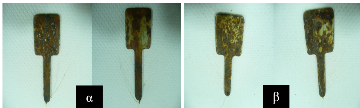
Εικόνα 5.56: Σύγκριση του δείγματος 1 (εικόνα α) St37 χωρίς διαμόρφωση στους 1000°C, χωρίς αμμοβολή και με επικάλυψη Μίνιο και του δείγματος 4 (εικόνα β) St37 χωρίς διαμόρφωση στους 1000°C, με αμμοβολή και με επικάλυψη Μίνιο στις 20 ημέρες παραμονής στο θάλαμο αλατονέφωσης. (Στα αριστερά κάθε εικόνας είναι με προ-χαραγή και δεξιά χωρίς χαραγή)
