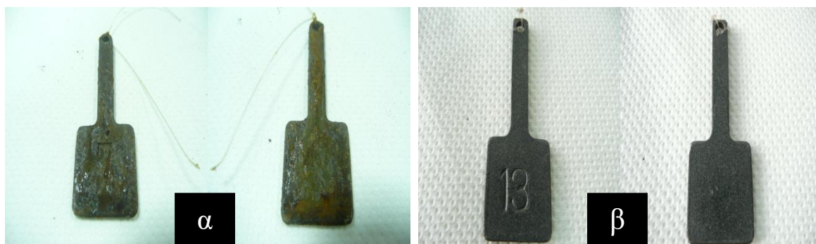
Εικόνα 5.47: Σύγκριση του δείγματος 7* (εικόνα α) St37 dcp χωρίς διαμόρφωση στους 1000°C, με αμμοβολή και με επίστρωση Paramatti και του δείγματος 13 (εικόνα β) Stainless Steel 304 χωρίς διαμόρφωση στους 1000°C, με αμμοβολή και με επίστρωση Paramatti για τις 21 και 31 ημέρες αντίστοιχα παραμονής τους στο θάλαμο αλατονέφωσης. (Στα αριστερά κάθε εικόνας είναι με προ-χαραγή και δεξιά χωρίς χαραγή)
