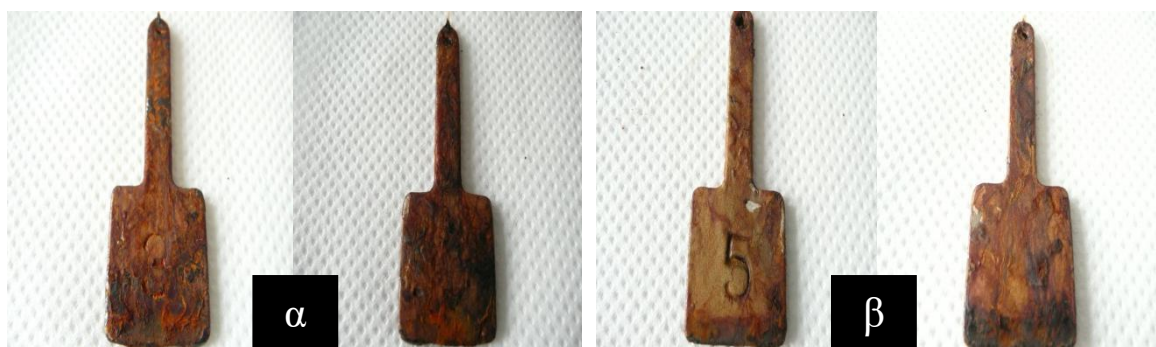
Εικόνα 5.58: Σύγκριση δείγματος 3 (εικόνα α) St37 dcp χωρίς διαμόρφωση στους 1000°C, χωρίς αμμοβολή με επικάλυψη Gridox και Alcea και του δείγματος 5 (εικόνα β) St37 dcp χωρίς διαμόρφωση στους 1000°C, με αμμοβολή με επικάλυψη Gridox και Alcea στις 75 ημέρες παραμονής στο θάλαμο αλατονέφωσης. (Στα αριστερά κάθε εικόνας είναι με προ-χαραγή και δεξιά χωρίς χαραγή)
