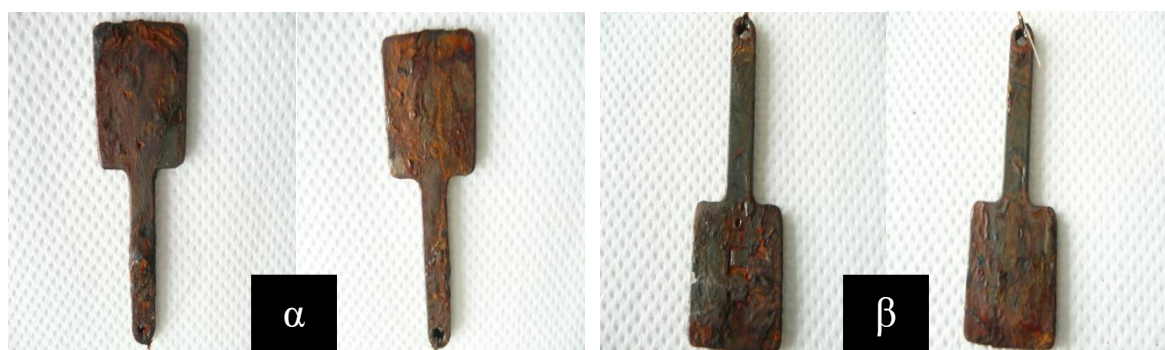
Εικόνα 5.59: Σύγκριση δείγματος 3* (εικόνα α) St37 dcp χωρίς διαμόρφωση στους 1000°C, χωρίς αμμοβολή με επικάλυψη Gridox και Paramatti και του δείγματος 5* (εικόνα β) St37 dcp χωρίς διαμόρφωση στους 1000°C, με αμμοβολή με επικάλυψη Gridox και Paramatti στις 75 ημέρες παραμονής στο θάλαμο αλατονέφωσης. (Στα αριστερά κάθε εικόνας είναι με προ-χαραγή και δεξιά χωρίς χαραγή)
