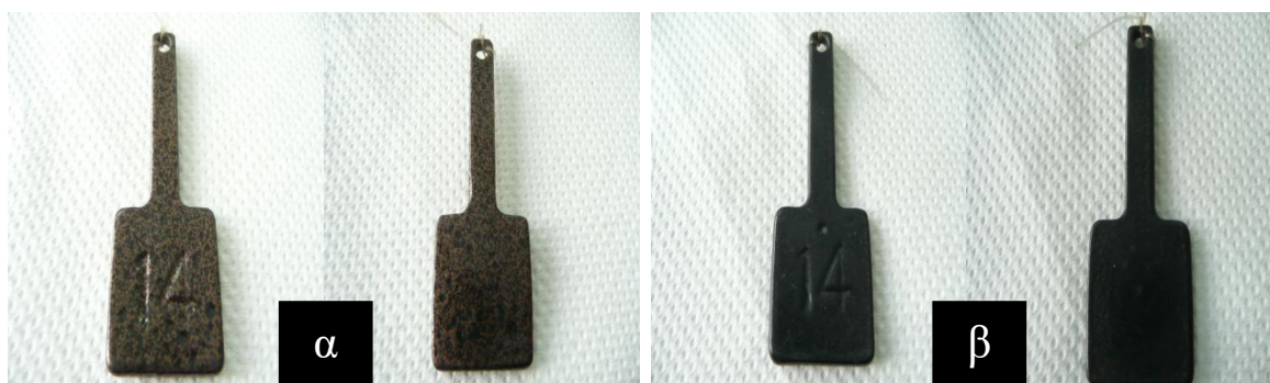
Εικόνα 5.43: Σύγκριση του δείγματος 14 (εικόνα α) Stainless Steel 304 χωρίς διαμόρφωση στους 1000°C, με αμμοβολή και με ηλεκτροστατική ψευδαργύρωση και ηλεκτροστατική σφυρήλατη και του δείγματος 14* (εικόνα β) Stainless Steel 304 χωρίς διαμόρφωση στους 1000°C, με αμμοβολή και με ηλεκτροστατική ψευδαργύρωση και ηλεκτροστατική επίπεδη στις 100 ημέρες παραμονής στο θάλαμο αλατονέφωσης. (Στα αριστερά κάθε εικόνας είναι με προ-χαραγή και δεξιά χωρίς χαραγή)
