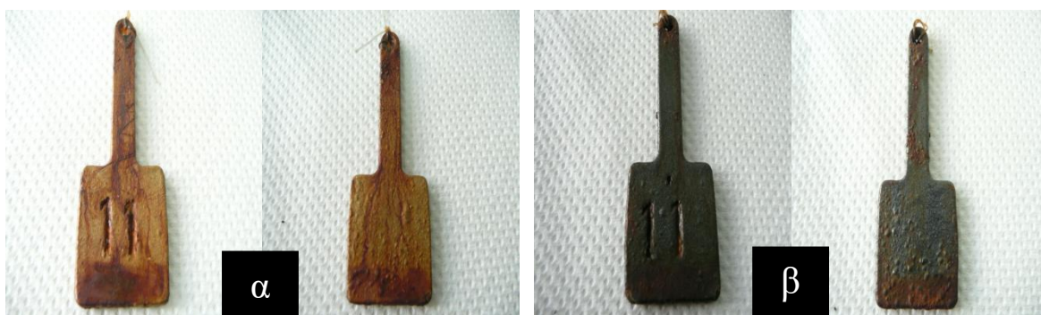
Εικόνα 5.41: Σύγκριση του δείγματος 11 (εικόνα α) St37 dcp χωρίς διαμόρφωση στους 1000°C, με αμμοβολή με επικάλυψη Γομωτής, Gridox και Alcea και του δείγματος 11* (εικόνα β) St37 dcp χωρίς διαμόρφωση στους 1000°C, με αμμοβολή και με επικάλυψη Γομωτής, Gridox και Paramatti στις 87 ημέρες παραμονής στο θάλαμο αλατονέφωσης. (Στα αριστερά κάθε εικόνας είναι με προ-χαραγή και δεξιά χωρίς χαραγή)
