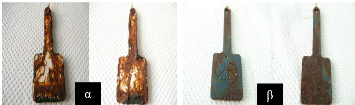
Εικόνα 5.55: Σύγκριση του δείγματος 26 (εικόνα α) Stainless Steel 304 χωρίς διαμόρφωση στους 1000°C, χωρίς αμμοβολή και με ηλεκτροστατική σφυρήλατη και του δείγματος 26* (εικόνα β) Stainless Steel 304 χωρίς διαμόρφωση στους 1000°C, χωρίς αμμοβολή και με ηλεκτροστατική ψευδαργύρωση και ηλεκτροστατική σφυρήλατη στις 100 ημέρες παραμονής στο θάλαμο αλατονέφωσης. (Στα αριστερά κάθε εικόνας είναι με προ-χαραγή και δεξιά χωρίς χαραγή)
