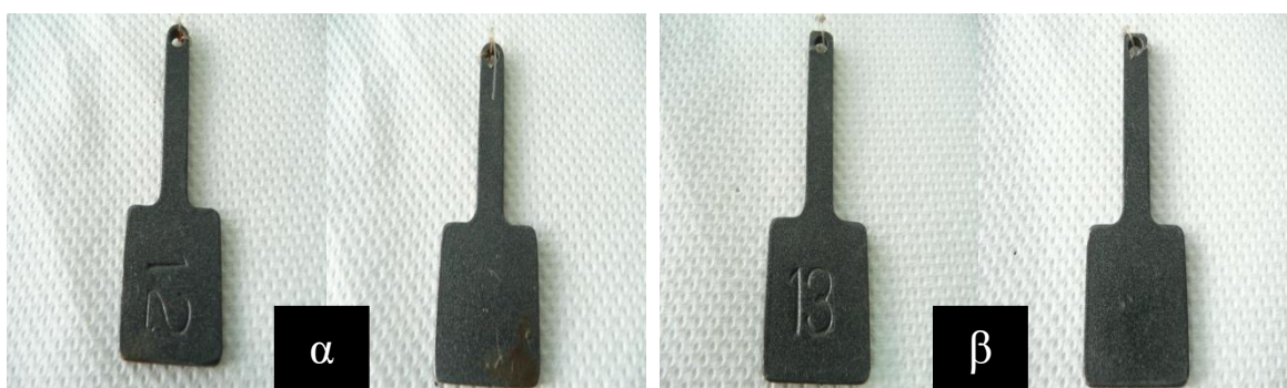
Εικόνα 5.48: Σύγκριση του δείγματος 12 (εικόνα α) Stainless Steel 316 χωρίς διαμόρφωση στους 1000°C, με αμμοβολή και με επίστρωση Paramatti και του δείγματος 13 (εικόνα β) Stainless Steel 304 χωρίς διαμόρφωση στους 1000°C, με αμμοβολή και με επίστρωση Paramatti για τις 100 ημέρες παραμονής τους στο θάλαμο αλατονέφωσης. (Στα αριστερά κάθε εικόνας είναι με προ-χαραγή και δεξιά χωρίς χαραγή)
