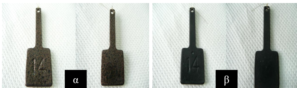
Εικόνα 5.54: Σύγκριση του δείγματος 14 (εικόνα α) Stainless Steel 304 χωρίς διαμόρφωση στους 1000°C, με αμμοβολή και με ηλεκτροστατική ψευδαργύρωση και ηλεκτροστατική σφυρήλατη και του δείγματος 14* (εικόνα β) Stainless Steel 304 χωρίς διαμόρφωση στους 1000°C, με αμμοβολή και με ηλεκτροστατική ψευδαργύρωση και ηλεκτροστατική επίπεδη στις 100 ημέρες παραμονής στο θάλαμο αλατονέφωσης. (Στα αριστερά κάθε εικόνας είναι με προ-χαραγή και δεξιά χωρίς χαραγή)
