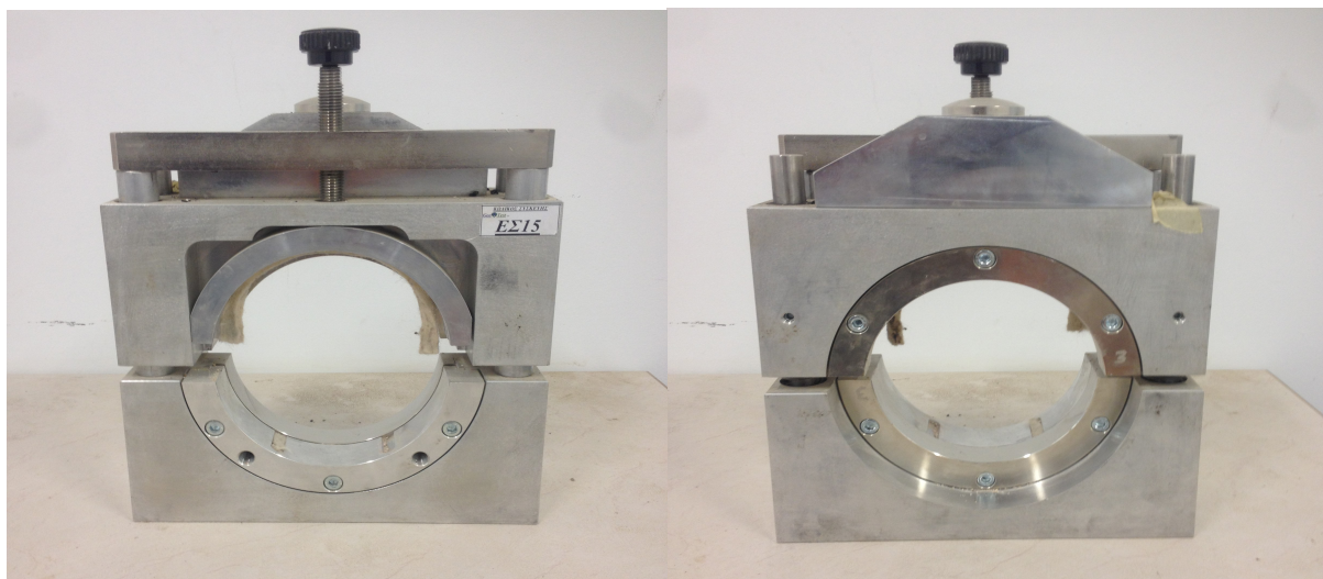
Εικόνα 14: Συσκευή διάτμησης Leutner
