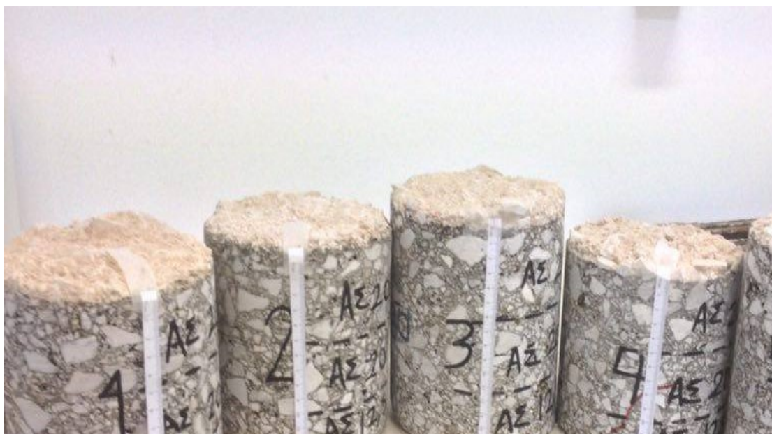
Εικόνα 19: Ασφαλτικοί πυρήνες-όρια στρώσεων-ύψη
