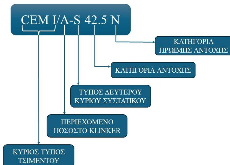
Εικόνα 4. Εξήγηση συμβολισμού των διάφορων κατηγοριών τσιμέντου.
