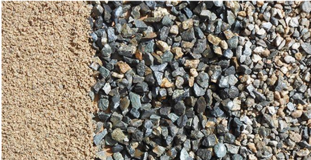
Εικόνα 7. Παράδειγμα αδρανών από τα αριστερά προς τα δεξιά αμμος, χαλίκι και γαρμπίλι
