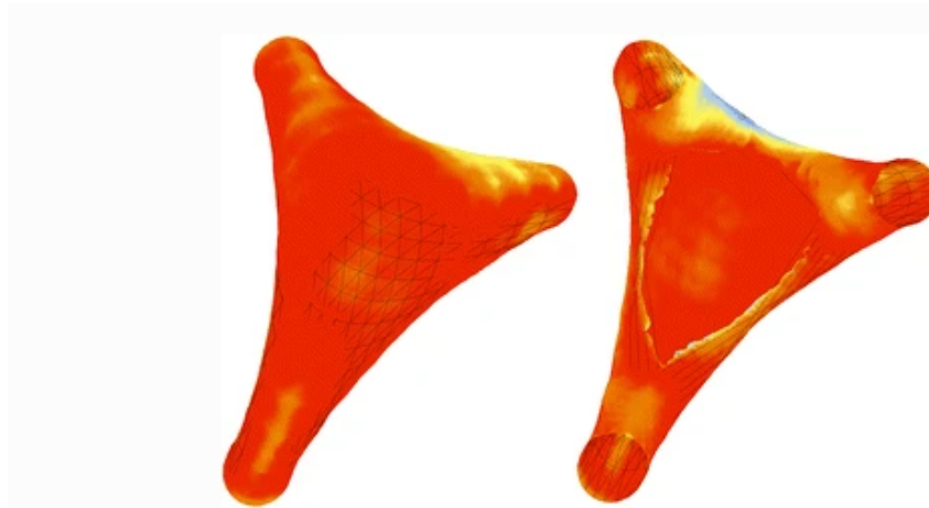
Εικ.19: Σύγκριση μεταξύ του τελικού ψηφιακού μοντέλου και του τρίτου φυσικού πρωτοτύπου που έχει σαρωθεί σε κλίμακα 3D: κόκκινο = μικρότερη από 50 χιλιοστά απόκλιση, μπλε = απόκλιση μεγαλύτερη από 1000 χιλιοστά.
