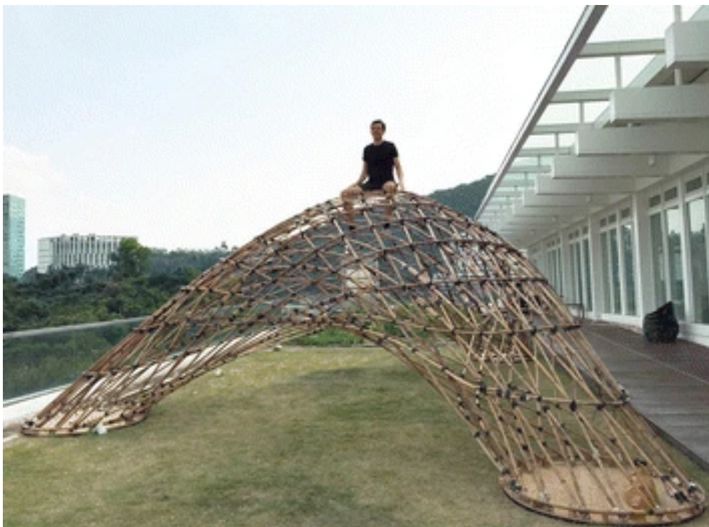
Εικ.17: Δεύτερο πρότυπο, που χρησιμοποιείται για την αξιολόγηση της δομικής συμπεριφοράς (rattan, 1:4)
