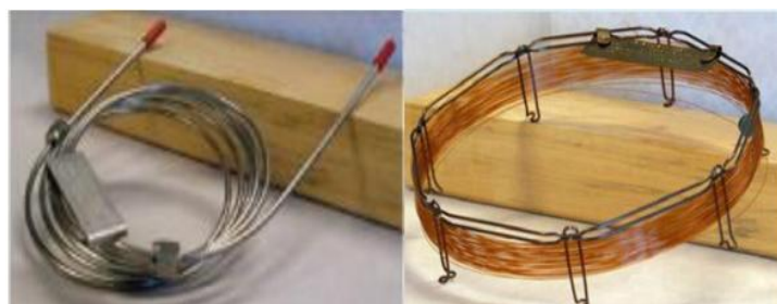
Εικόνα 19 αριστερά: πληρωμένη στήλη δεξιά: τριχοειδής στήλη
