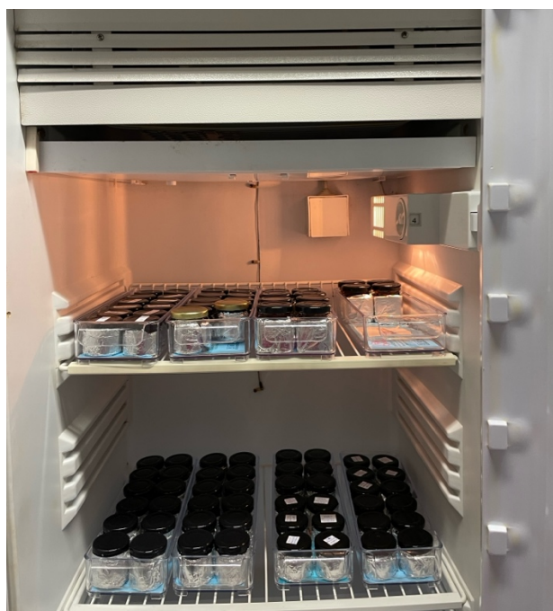
Εικόνα 12. Θάλαμος αποθήκευσης δειγμάτων στους 22°C.
