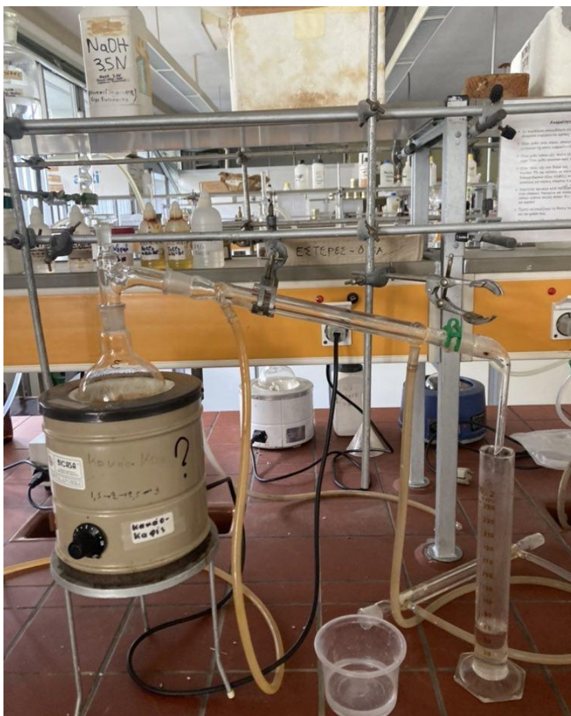
Εικόνα 9. Διάταξη απλής απόσταξης.
