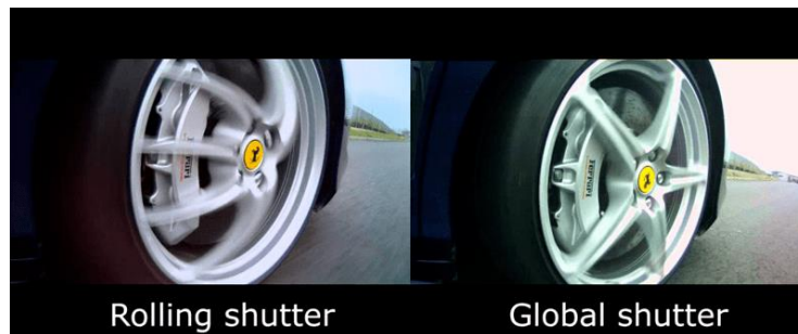
Εικόνα 3-4: Rolling Shutter & Global Shutter effect 4 .
