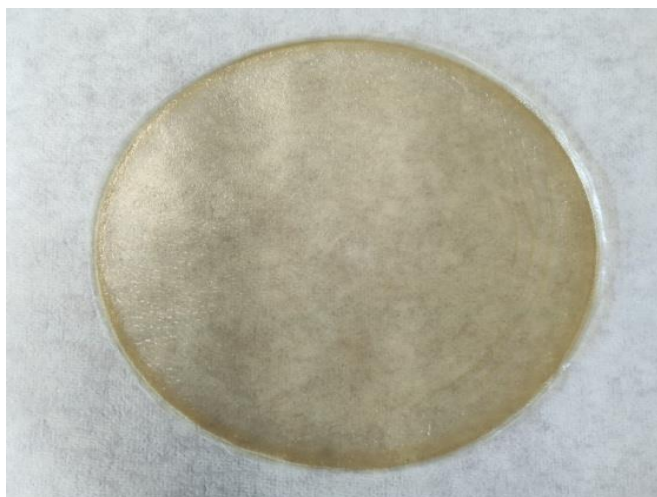
Εικόνα 4 : Κυκλική μεμβράνη από γλουτένη σίτου τοποθετημένη σε διηθητικό χαρτί
