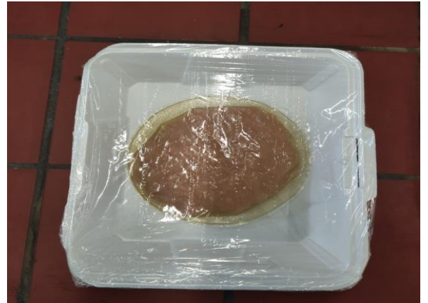
Εικόνα 6: Κιμάς κοτόπουλο συσκευασμένος σε μεμβράνες από γλουτένη σίτου τοποθετημένος σε δίσκο από πολυστυρόλιο (PS) και περιτυλιγμένος με μεμβράνη χαμηλής πυκνότητας πολυαιθυλενίου (LDPE)
