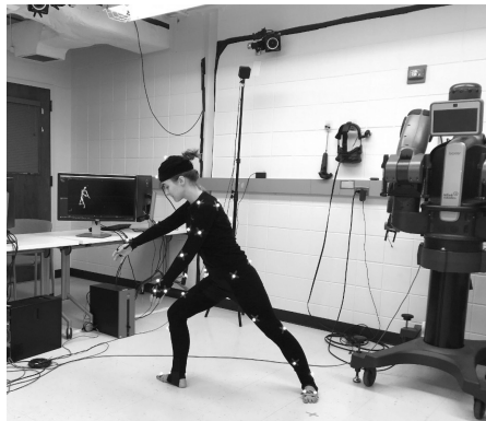
«Καταγραφή κίνησης με παθητικούς, ανακλαστικούς δείκτες στο εργαστήριο RAD του Πανεπιστημίου Illinois Urbana-Champaign. Η οθόνη του υπολογιστή εμφανίζει το τρισδιάστατο μοντέλο της κίνησης [...]»
