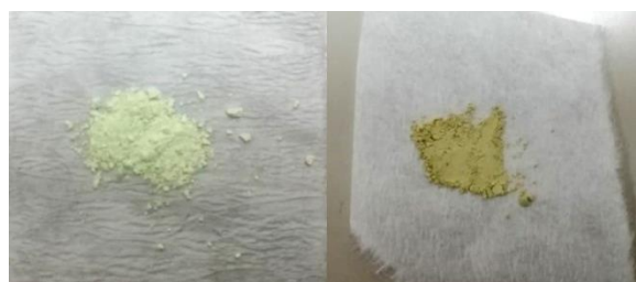
Εικόνα 3.7: Το Al-MOF όπως συντίθεται (αριστερά) και μετά την ρόφηση διχρωμικών (δεξιά).
