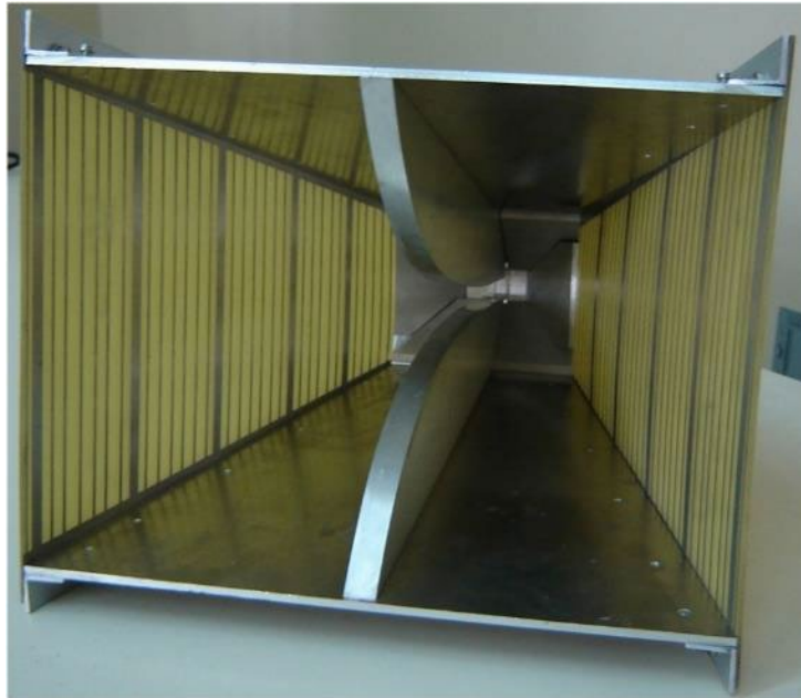
Σχήμα 3.10: Η κεραία χοάνης που χρησιμοποιήθηκε στο σύστημα του πομπού.
