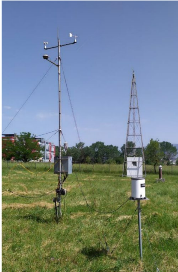
Σχήμα 5.1: Ο αυτόματος μετεωρολογικός σταθμός του Πανεπιστημίου Ιωαννίνων.
