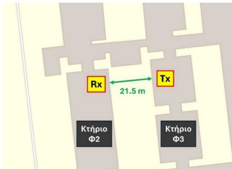
Σχήμα 5.11: Η τοποθέτηση του πομπού (Tx) και του δέκτη (Rx) στα κτήρια Φ2 και Φ3 του Τμήματος Φυσικής του Πανεπιστημίου Ιωαννίνων, για τη διεξαγωγή των μετρήσεων.
