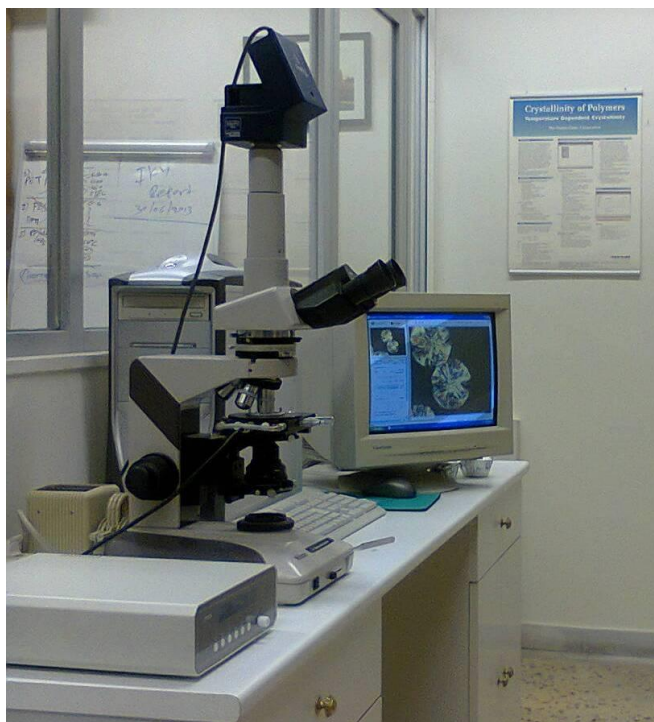
Εικόνα 29. Πολωτικό μικροσκόπιο που χρησιμοποιήθηκε για τη μελέτη της μορφολογίας των πολυμερικών μιγμάτων.
