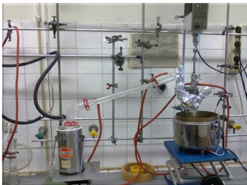
Εικόνα 22. Συσκευή πολυμερισμού που χρησιμοποιήθηκε για τη σύνθεση των PET, PEF.
