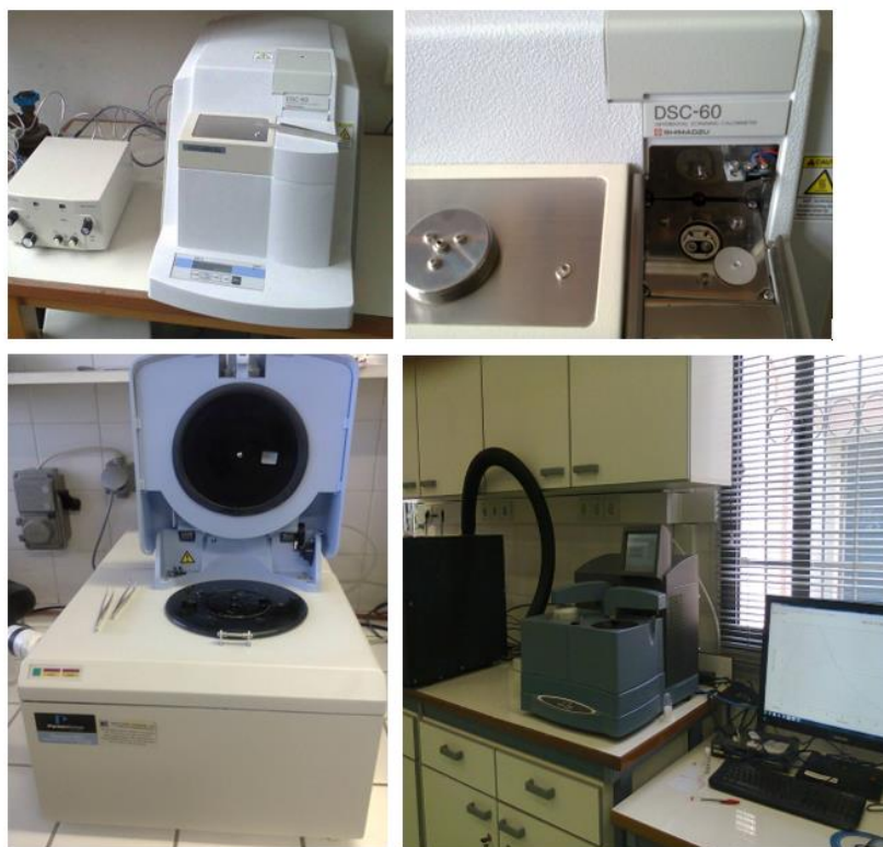
Εικόνα 27. Θερμιδόμετρο DSC που χρησιμοποιήθηκε για τη θερμική μελέτη των πολυμερικών μιγμάτων.
