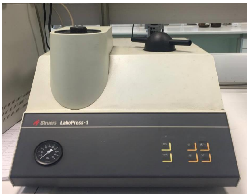
Εικόνα 16: Εγκιβωτιστικό μηχάνημα Struers – Labopress – 1.
