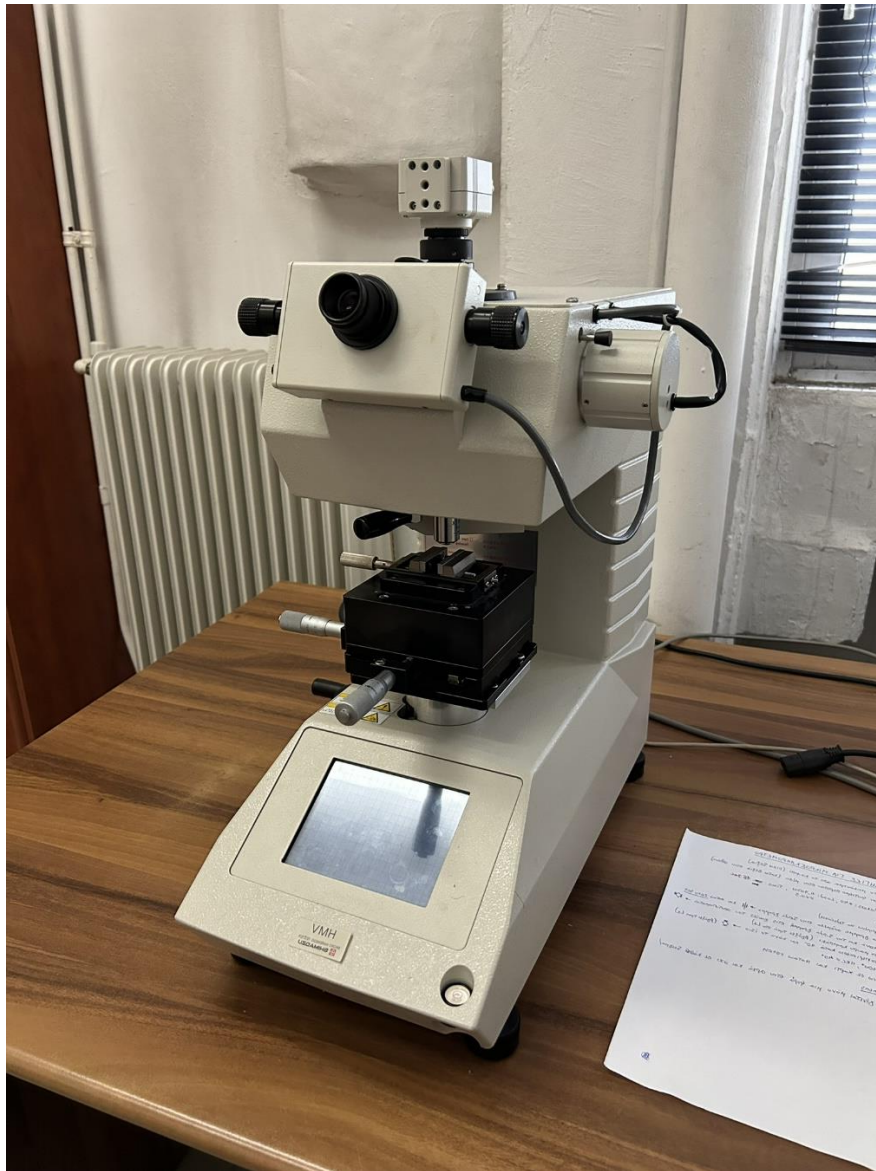
Εικόνα 22: Μικροσκληρόμετρο Shimadzu HV – 2.
