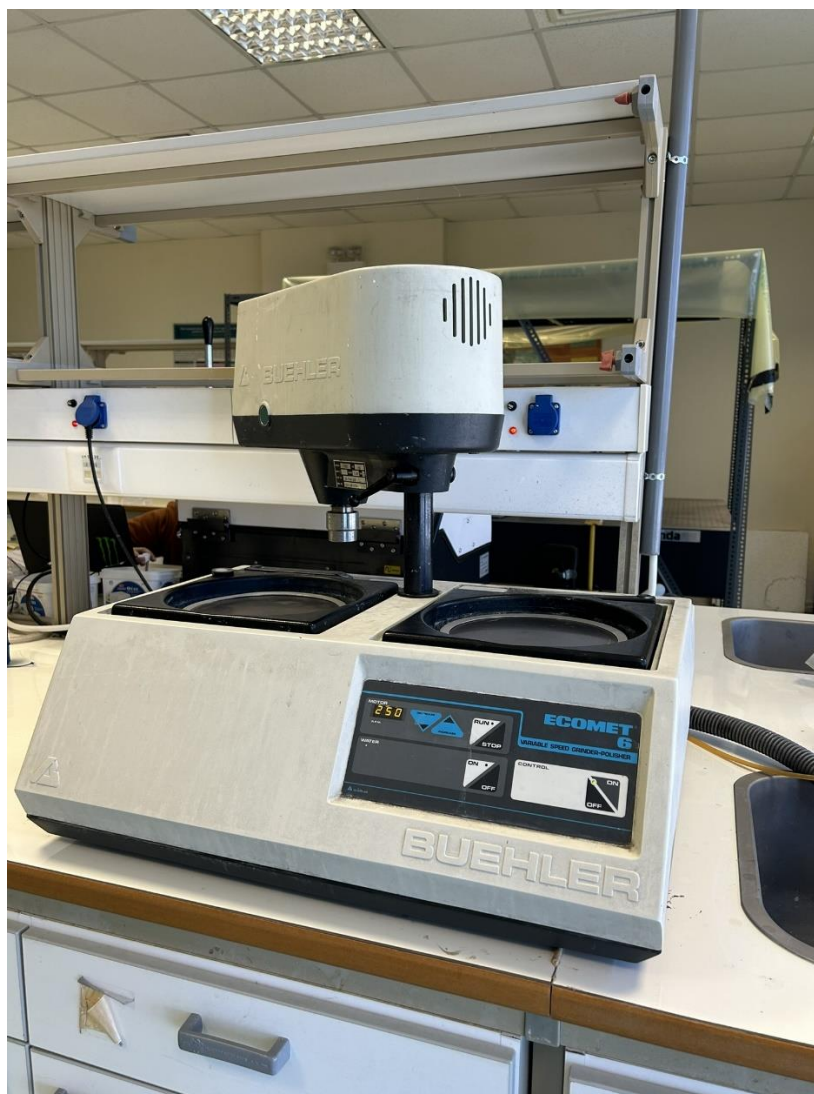
Εικόνα 17: Μηχάνημα λείανσης – στίλβωσης ECOMET 6 της εταιρίας BUEHLER.
