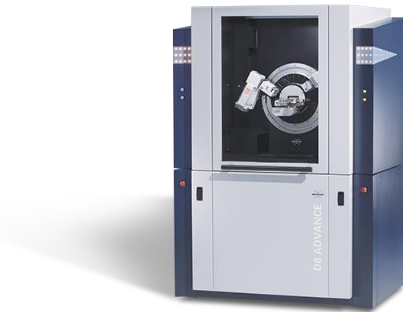
Εικόνα 27: Διάταξη περίθλασης ακτίνων – X (XRD) D8 Advance Bruker.
