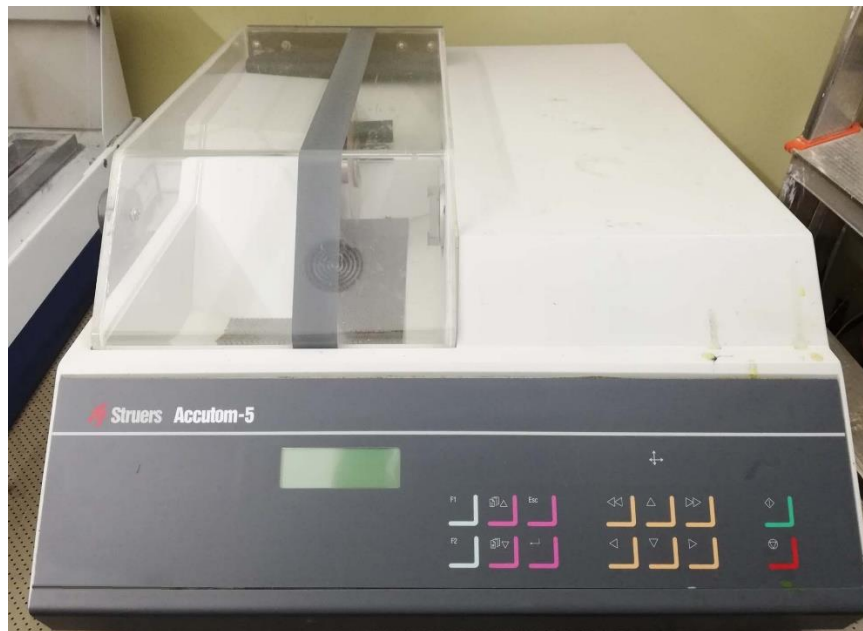
Εικόνα 19: Κοπτικό μηχάνημα Struers – Accutom – 5.
