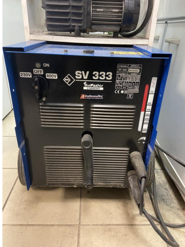
Εικόνα 15: Βιομηχανικός μετασχηματιστής CREMONT SV 333.
