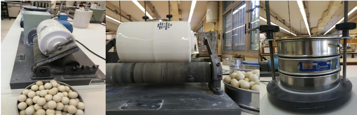
Εικόνα 7.2: Εργαστηριακός σφαιρόμυλος που χρησιμοποιήθηκε για την ελάττωση του μεγέθους των σωματιδίων της λυματολάσπης (αριστερά) και εργαστηριακά κόσκινα των 500 και 250 \mu\text{m} για την κατανομή μεγέθους σωματιδίων.
