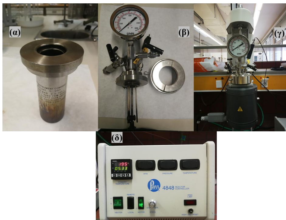
Εικόνα 6.1: Πειραματική διάταξη υδροθερμικής επεξεργασίας: (α) αντιδραστήρας - αυτόκλειστο, (β) κεφαλή, (γ) κυλινδρικό θερμαντικό σώμα που περιέχει το αυτόκλειστο, (δ) ηλεκτρονικός ρυθμιστής θερμοκρασίας και λειτουργίας.
