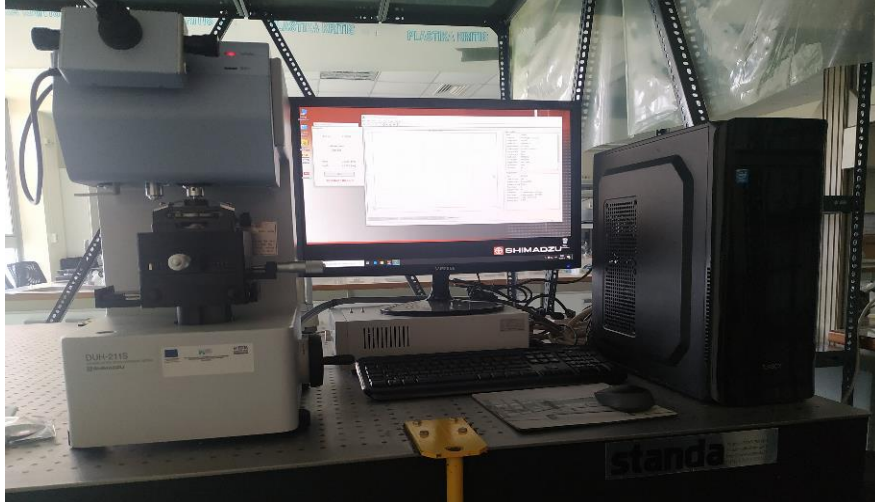
Εικόνα 42 : Νανοδιεσδυτής Schimadzu DUH-211S του εργαστηρίου μεταλλουργίας της εταιρείας (Dynamic ultra micro hardness tester)
