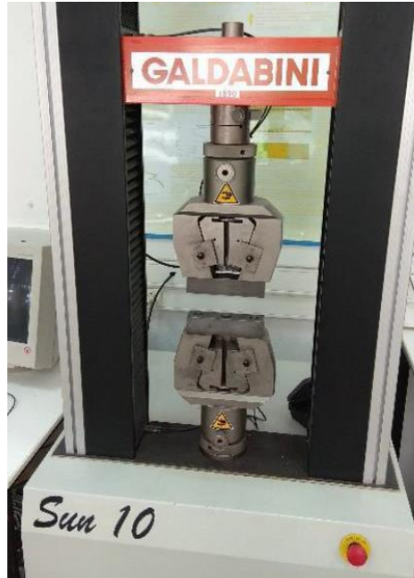
Εικόνα 38: Μηχανή εφελκυσμού -Θλίψης Galdabini Sun 10 με προσαρμοσμένες τις βάσεις για τη δοκιμή της θλίψης
