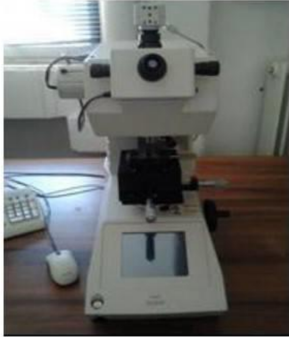
Εικόνα 36 :Το μικροσκληρόμετρο Schimadzu HV του εργαστηρίου στο οποίο μετρήθηκε η μικροσκληρότητα του κράματος.
