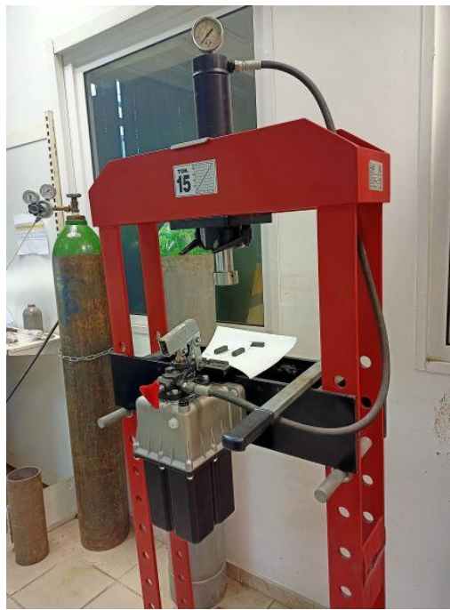
Εικόνα 31 Η υδραυλική πρέσα του εργαστηρίου εφαρμοσμένης μεταλλουργίας στην οποία γίνεται η συμπίεση των μεταλλικών κόνεων προς σχηματισμό του pellet.
