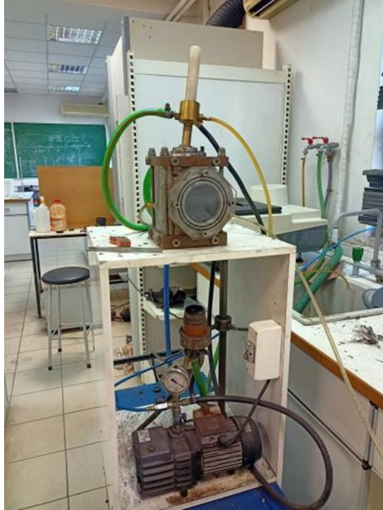
Εικόνα 32 :Ο φούρνος τόξου εν κενώ(VAM) του εργαστηρίου εφαρμοσμένης μεταλλουργίας.Στο κάτω μέρος διακρίνεται η μηχανική αντλία κενού.
