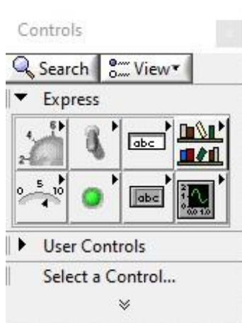
Σχήμα 4.3: Η Control Palette του Front panel
