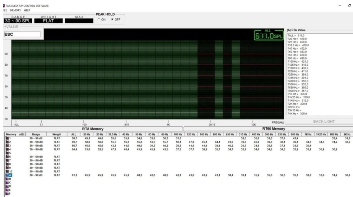
Σχήμα 5.7: Αποτελέσματα από μετρήσεις θορύβου με το όργανο μέτρησης Phonic PAA3 καταγράφοντας το επίπεδο θορύβου ανά συχνότητα( \Gamma_2(\gamma_2) )
