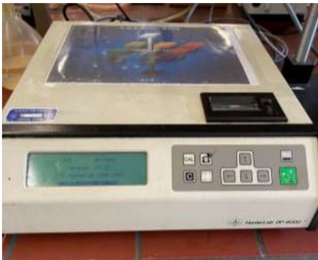
Εικόνα 10. Χρωματόμετρο Hunter Lab μοντέλου DP-9000 optical sensor colorimeter
