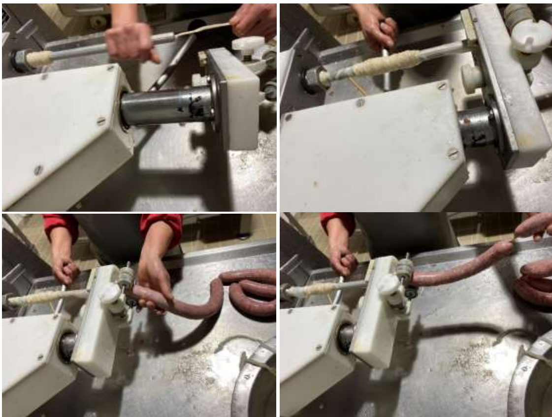
Εικόνες 7. Ενθήκευση του μίγματος με την χρήση γεμιστικού μηχανήματος.
