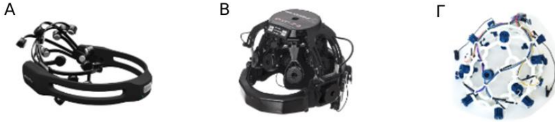
Εικόνα 11: Απεικόνιση τριών διαφορετικών τύπων φορεσιμών συσκευών ΗΕΓ: (Α) Emotiv Eroc Plus: Φορητή συσκευή EEG κατάλληλη για καταγραφή και ανάλυση εγκεφαλικών σημάτων σε καθημερινές συνθήκες. (Β) DSI-24: Προηγμένη συσκευή ΗΕΓ με πολλαπλά ηλεκτρόδια, σχεδιασμένη για λεπτομερή έρευνα. (Γ) OpenBCI: Δικτυωτή κάσκα ΗΕΓ με ευέλικτο σχεδιασμό, κατάλληλη για υψηλής ακρίβειας καταγραφές
