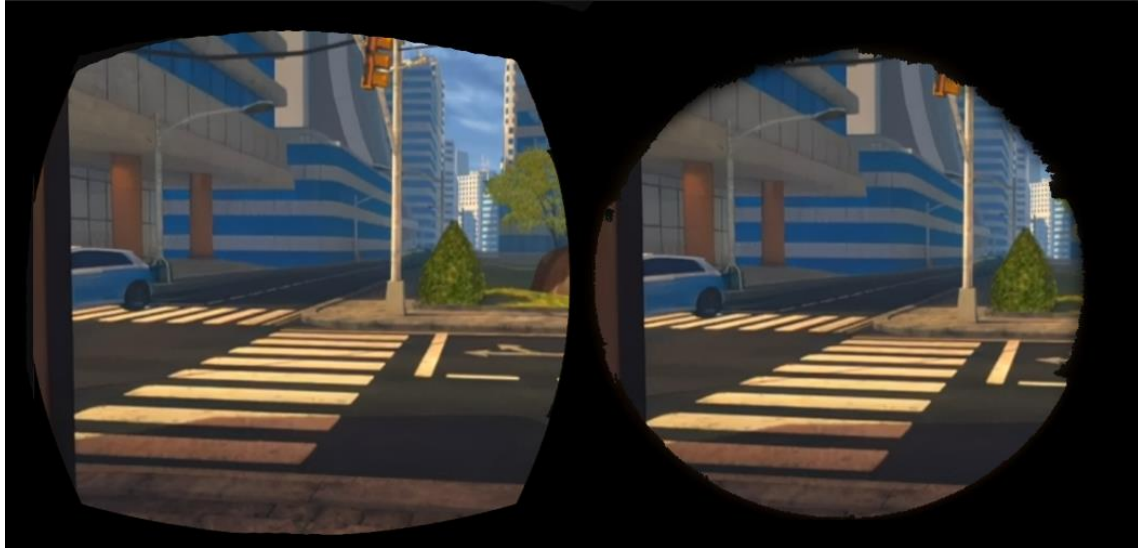
Εικόνα 15: Η εικόνα απεικονίζει τη διαφορά στο οπτικό πεδίο που προσφέρεται από διαφορετικά HMD. Αριστερά, φαίνεται ένα ευρύτερο οπτικό πεδίο, ενώ δεξιά, ένα στενότερο, καταδεικνύοντας πως η εμπειρία θέασης ποικίλλει ανάλογα με το FOV της εκάστοτε συσκευής
