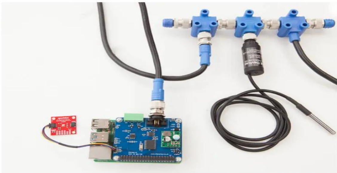
Εικόνα 26.Nmea 2000 δίκτυο συνδεδεμένο σε rican-m.[6]
