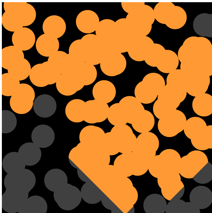
Σχήμα 6.3: Μοντελοποίηση κυκλικών επικαλυπτόμενων σωματιδίων με διάδοση και εφαρμογή του Depth First Search για την εύρεση της διαδρομής διάδοσης (σκούρο γκρι).
