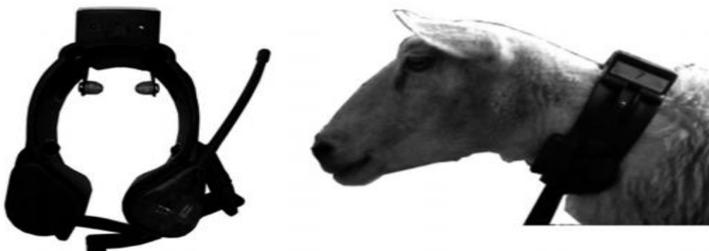
Εικόνα 6: Περιλαίμιο ηχητικής σήμανσης και ηλεκτρικής διέγερσης των προβάτων
