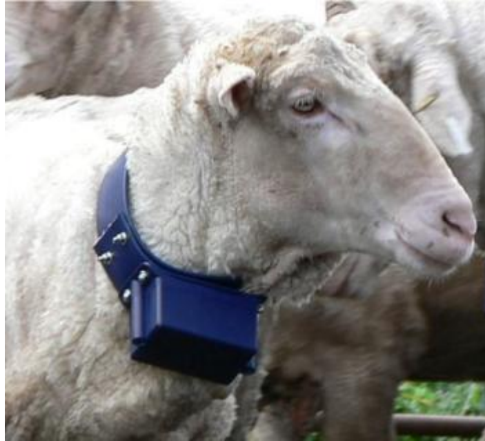
Εικόνα 4: Αισθητήρας αναγνώρισης της θέσης των προβάτων με GPS
