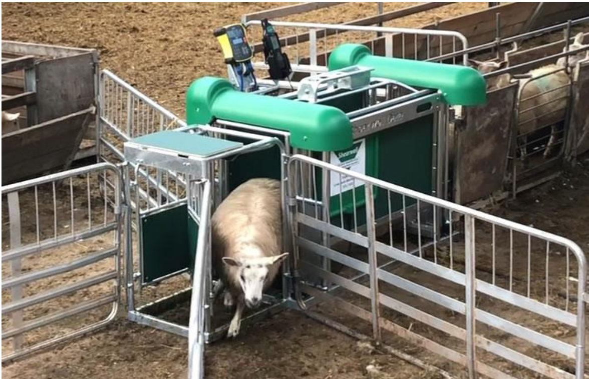
Εικόνα 5: Σύστημα αναγνώρισης και καταμέτρησης του βάρους των προβάτων
