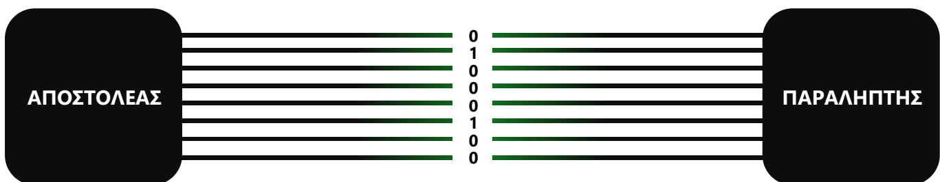
Σχηματικό 4: Η παράλληλη μετάδοση, χρησιμοποιεί πολλαπλά κανάλια επικοινωνίας, και κάθε δεκαδικό ψηφίο διαθέτει μια ξεχωριστή γραμμή μετάδοσης.
