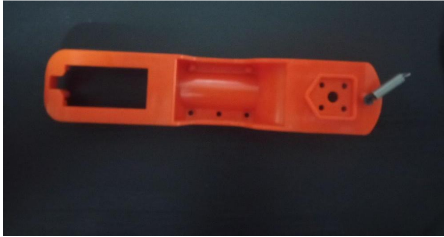
Εικόνα 5.6 Το δεύτερο πλαστικό μέρος με το ελατήριο
