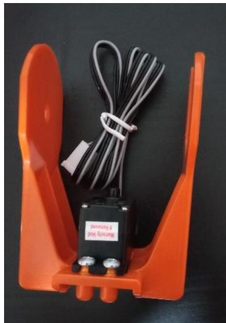
Εικόνα 5.16 Η βάση της αρπάγης με τον SpringRC SR311
