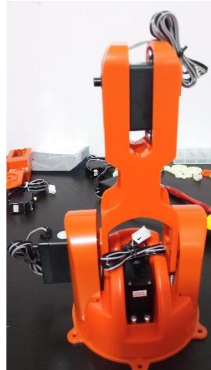
Εικόνα 5.15 Η βάση βιδωμένη με το υπόλοιπο πείραμα
