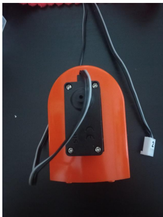
Εικόνα 5.5 Το πρώτο πλαστικό μέρος με τον σερβοκινητήρα βιδωμένο πάνω του
