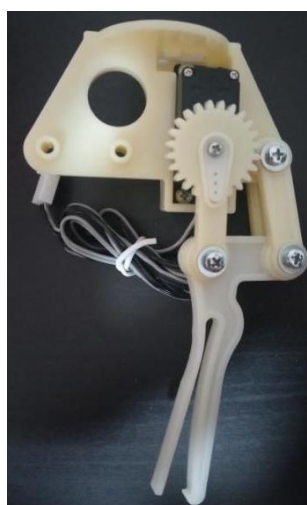
Εικόνα 5.19 Ένωση «δαγκάνας» ενωμένο με SpringRC SR311
