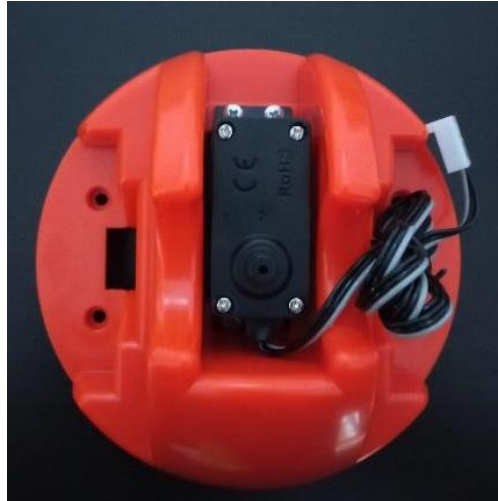
Εικόνα 5.12 Η κεφαλή της βάσης με τον SpringRC SR431
