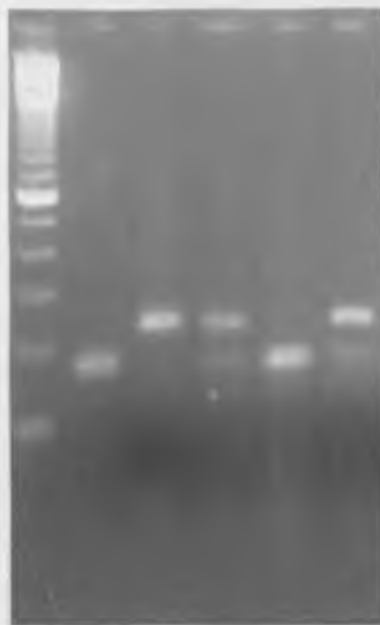
Εικόνα 11. Ζώνες που προκύπτουν κατά την ηλεκτροφόρηση των προϊόντων πέψης κατά τη διερεύνηση του πολυμορφισμού AluI του γονιδίου ERβ.
