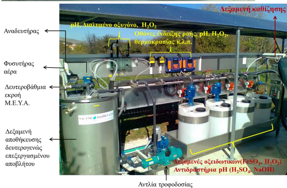
Εικόνα 6.2. Πιλοτική μονάδα φωτοκαταλυτικής επεξεργασίας δευτερογενών νοσοκομειακών αποβλήτων, εγκατεστημένη στο Πανεπιστημιακό Γενικό Νοσοκομείο Ιωαννίνων.
