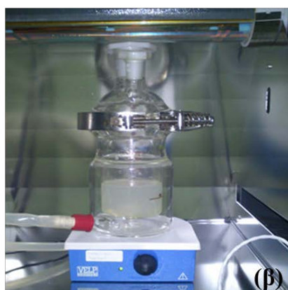
Εικόνα 6.1. (α) Προσομοιωτής ηλιακής ακτινοβολίας SUNTEST XLS+ της εταιρείας Atlas και (β) Γυάλινος αντιδραστήρας Duran® glass με συνεχή ανακυκλοφορία νερού βρύσης στο εσωτερικό του προσομοιωτή ηλιακής ακτινοβολίας.
