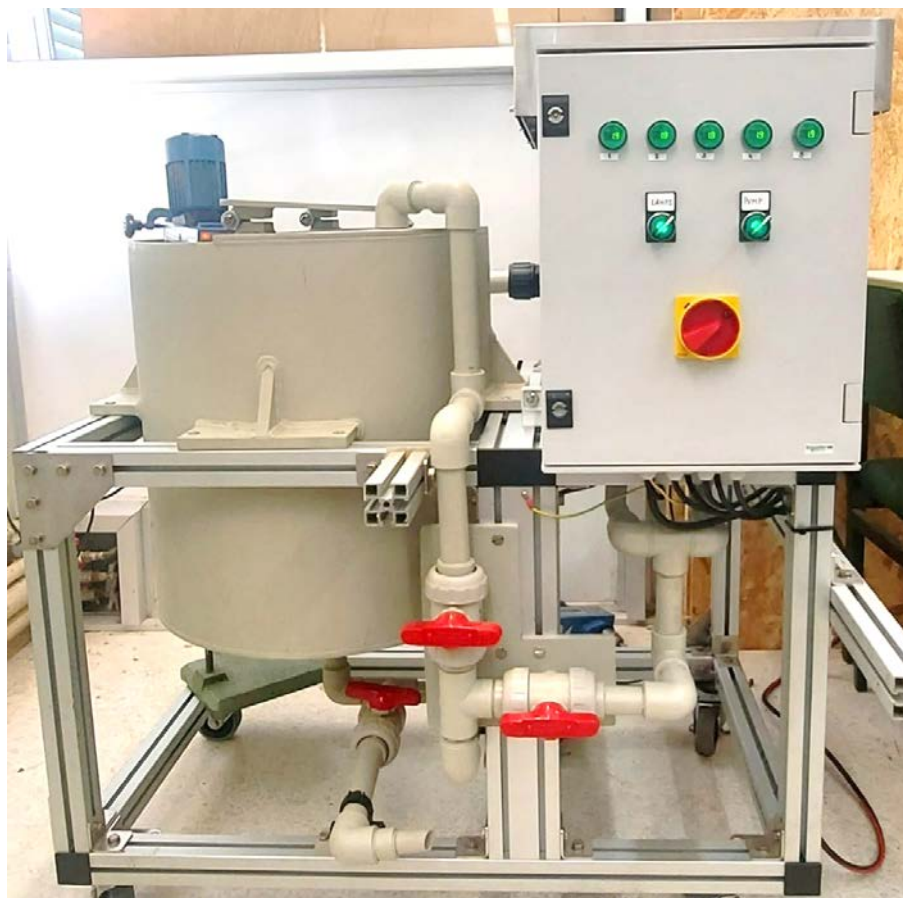
Εικόνα 6.3. Πιλοτική μονάδα εργαστηριακής κλίμακας για την φωτοκαταλυτική επεξεργασία υγρών αποβλήτων.
