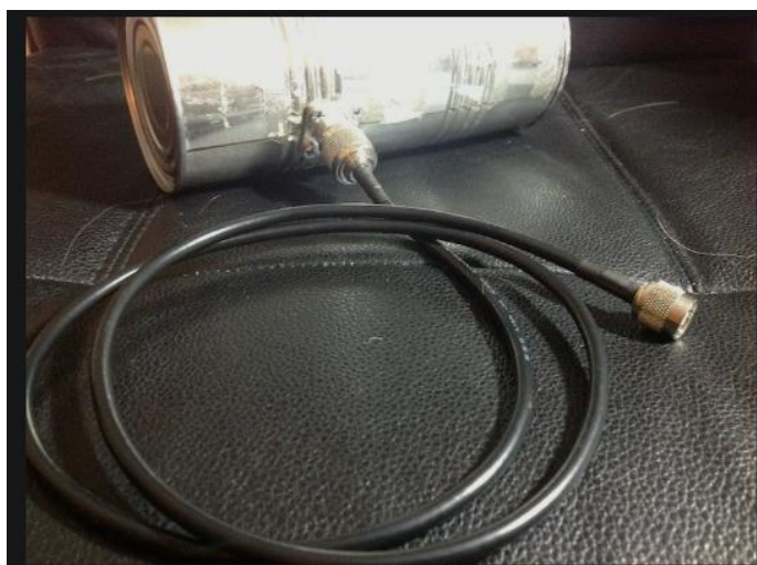
Εικόνα 22: Η cantenna με το pigtail.
