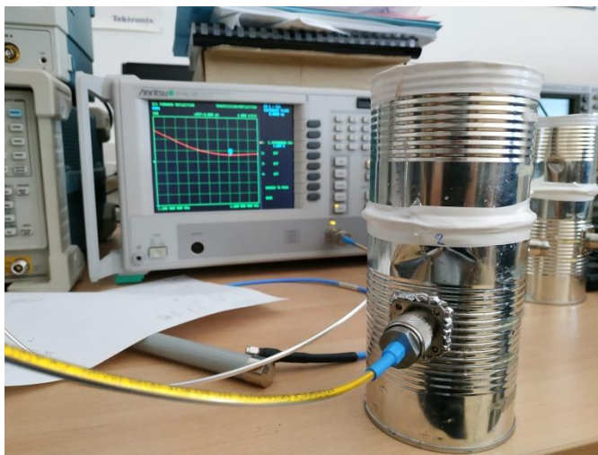
Εικόνα 35: Τελική κατασκευή της κεραίας 2.
