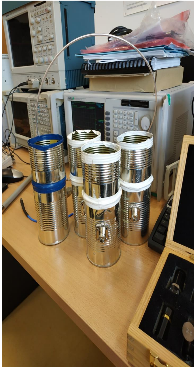
Εικόνα 29: Οι κεραίες που κατασκευάστηκαν από κουτιά αλουμινίου από την εμπρόσθια όψη, όπου φαίνονται και τα χάλκινα στοιχεία.
