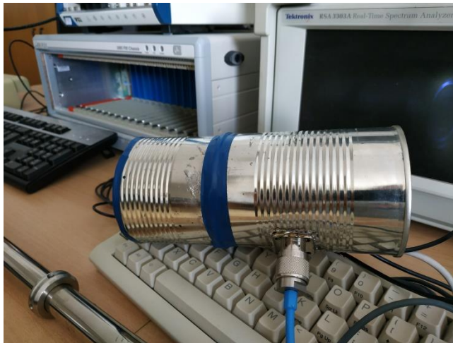
Εικόνα 31: Τελική κατασκευή της κεραίας 1.
