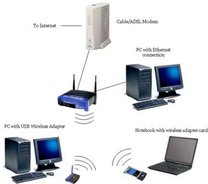
Εικόνα 2: Συνδεσμολογία των συσκευών σε ένα τοπικό δίκτυο ενσύρματα και ασύρματα.
