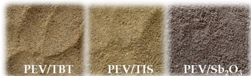
Εικόνα 13. Εμφάνιση τελικών δειγμάτων (α) PEV/TBT, (β) PEV/TIS και (γ) PEV/Sb 2 O 3 μετά από 4 ώρες πολυσυμπύκνωσης.
