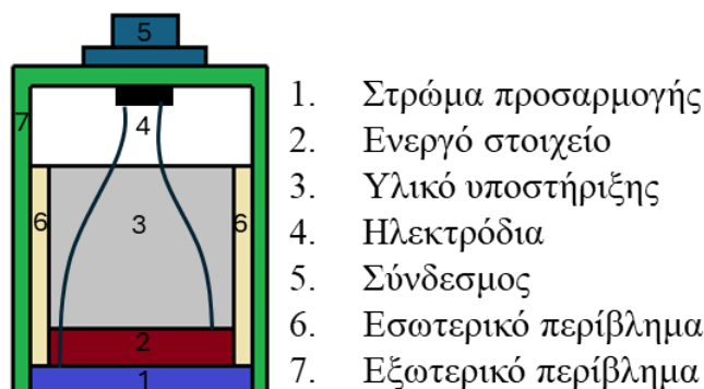
Εικόνα 2.3. Τυπική διάταξη πιεζοηλεκτρικού στοιχείου. Με διαφορετικά νούμερα και χρώματα εντοπίζονται τα διάφορα μέρη αυτού.
