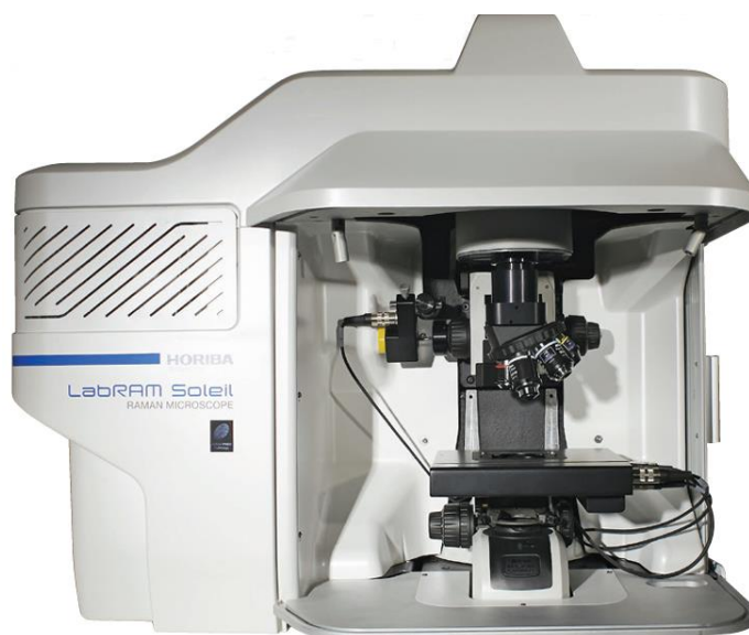
Εικόνα 7.5. Το φασματοφωτόμετρο micro-Raman της Horiba , μοντέλο LabRam Soleil .
